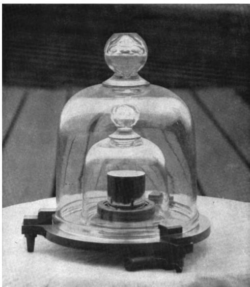
Obrázek 6.23: Český státní etalon hmotnosti ve tvaru rovnostranného válce [62]
