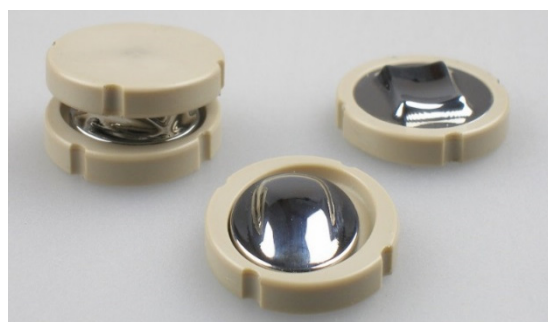
Obr. 5-18 Vzorky prototypů pro mechanické zkoušky v laboratoři na ČVUT FS, vyrobené z koncových materiálů (CoCrMo, PEEK)
