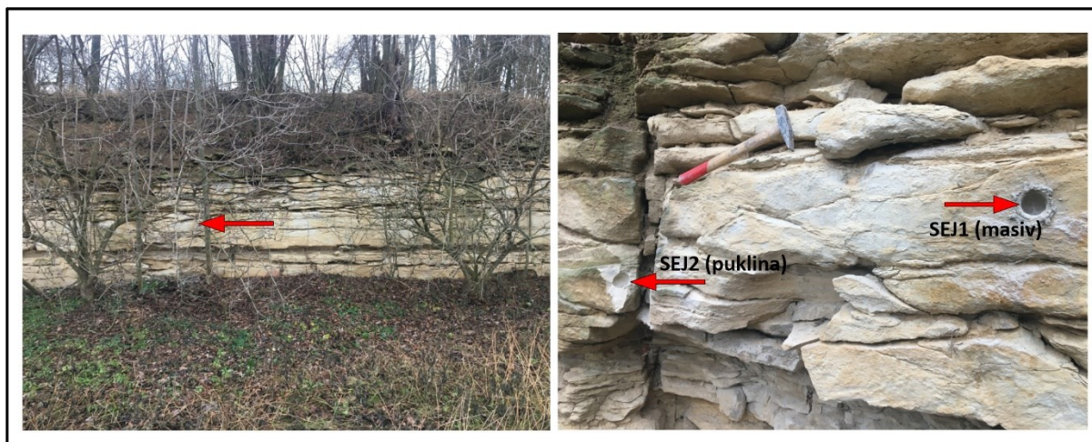
Obr. 6-40 Fotodokumentace výchozu jemnozrnných vápntých pískovců kolektoru Cb v bývalém lomu u Sejtinky. Oba vzorky vykazovaly podobné hodnoty obsahu rozpustné složky i původní porozity.
