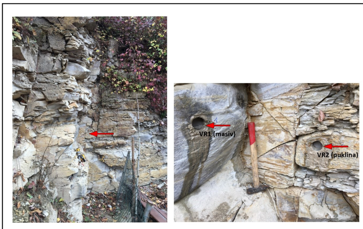
Obr. 6-52 Fotodokumentace výchozu a vzorkovaných míst na lokalitě Vraclav – Svatý Mikuláš - VR1 vápnitý pískovec, VR2 písčítý vápenec.
