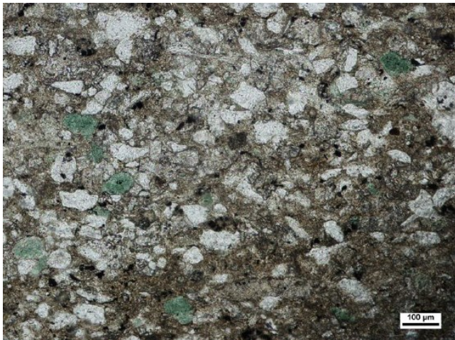
Obr. 6-20 Písčítý slinitý prachovec s příměsí glaukonitu a nízkou mírou silicifikace (převzato: Čech et al. 2015g)
