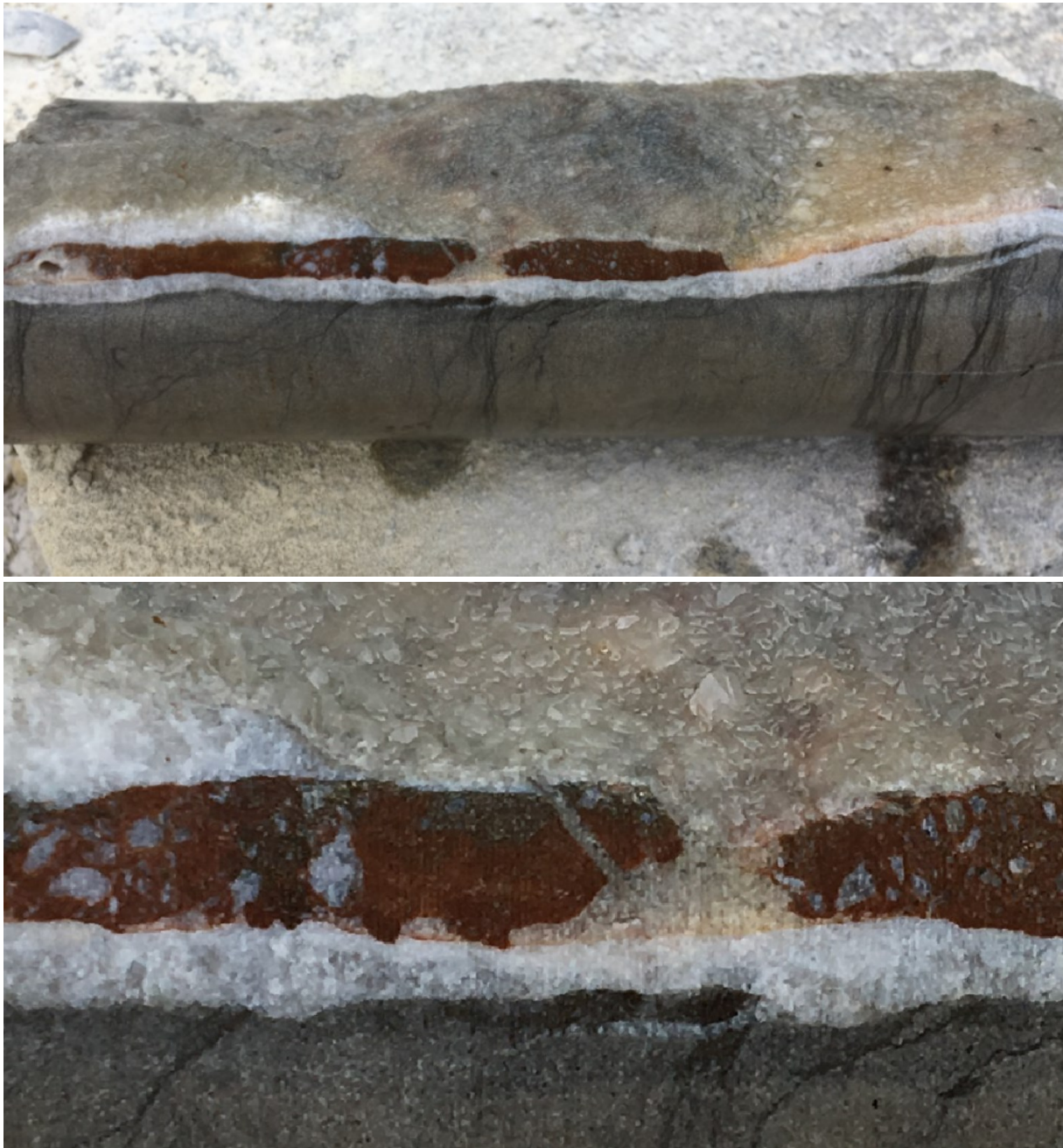
Obr. 6-4 Vzorek vrtného jádra z vrtu 4231_01W z hloubky 238,2 m + detail na dolní části obrázku. Otevřená subvertikální puklina je sekundárně zcela vyhojena krystalickým kalcitem se zřetelnými vyvinutými krystaly ve směru do pukliny; ve vnitřní části kalcitové výplně mladší sekundární limonitová impregnace s volně plovoucími úlomky krystalického kalcitu (brekcie)
