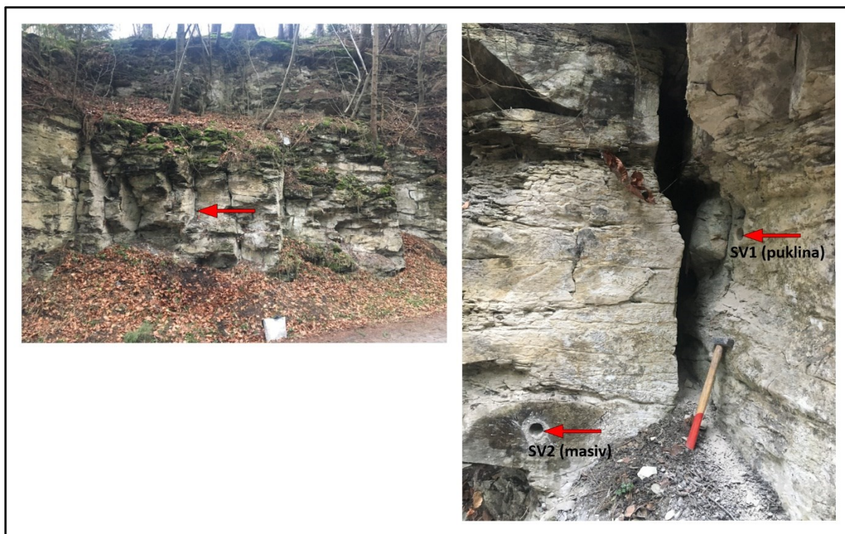
Obr. 6-42 Fotodokumentace výchozu jemnozrnných písčitých vápenců ve výchozu kolektoru Cb. Kalcitem bohaté polohy mají větší soudržnost a makroskopicky výrazně hladší povrch
