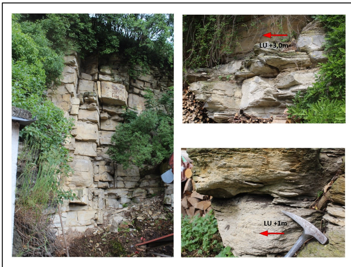
Obr. 6-46 Fotodokumentace výchozu jemnozrnných vápnitých pískovců (dolní část profilu) a písčitých vápenců (horní část profilu) ve výchozu kolektoru B při okraji údolní nivy Novohradky v Luži. Ve spodní části profilu je patrná intenzivnější vyloužení vrstev, způsobující ochuzení horniny kalcitem a vyšší míru porozity
