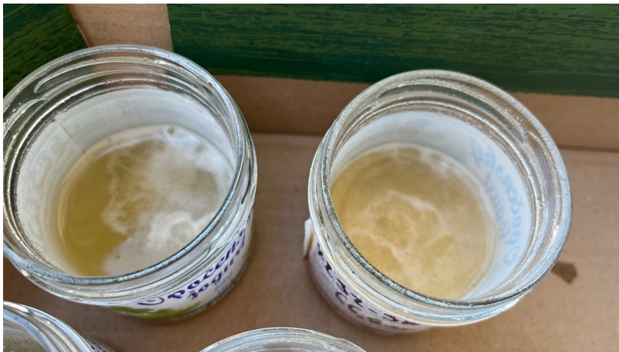
Obr. 5-2 Loužení vzorků v HCl (silně reaktivní vzorky)
