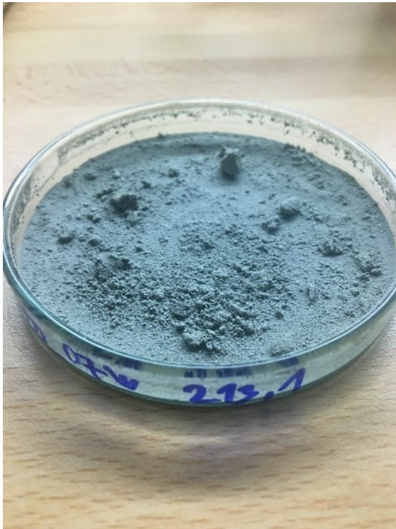
Obr. 5-3 Nesoudržná část vzorků (opad) po loužení v HCl
