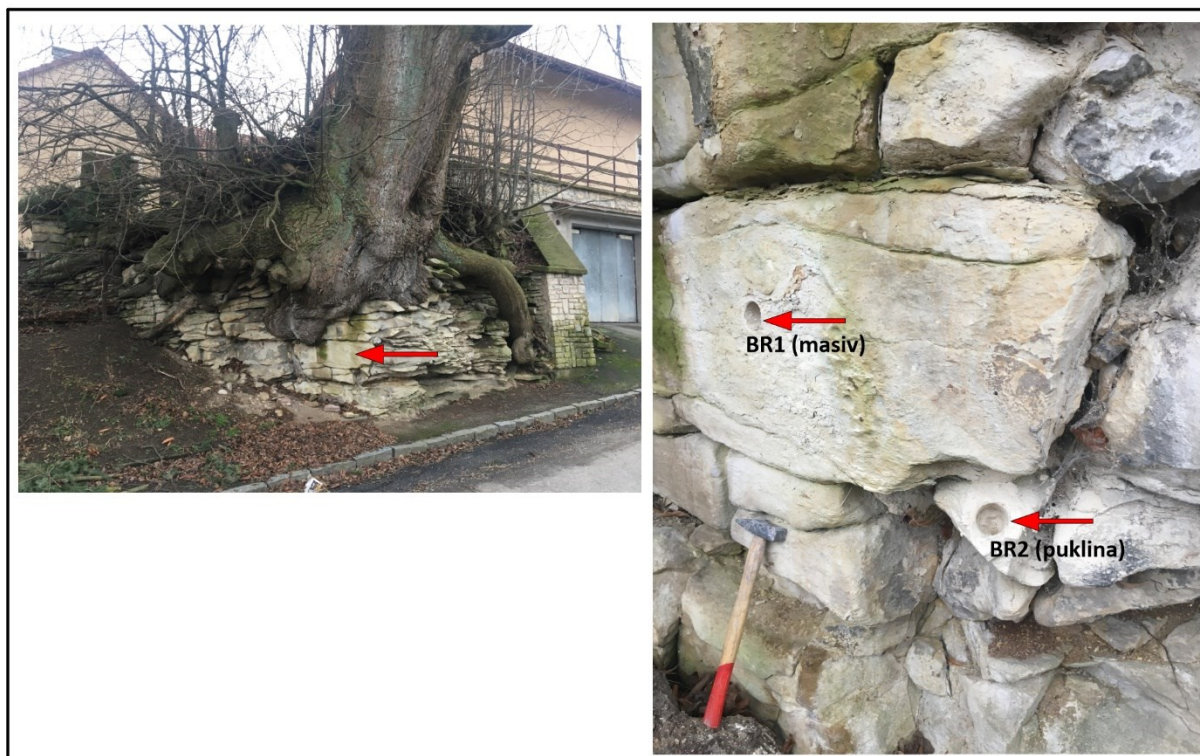
Obr. 6-30 Fotodokumentace výchozu jemnozrnných vápniých pískovců v Brtči, s intenzivním mechanickým rozpukáním kořeny stromů
