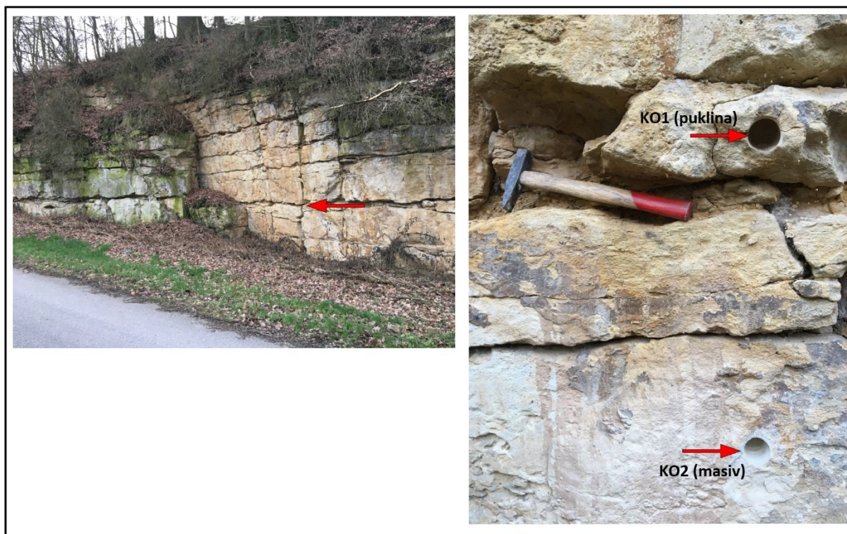
Obr. 6-31 Fotodokumentace výchozu jemnozrnných vápnitých pískovců Končínách, s typickou lavicovitou odlučností
