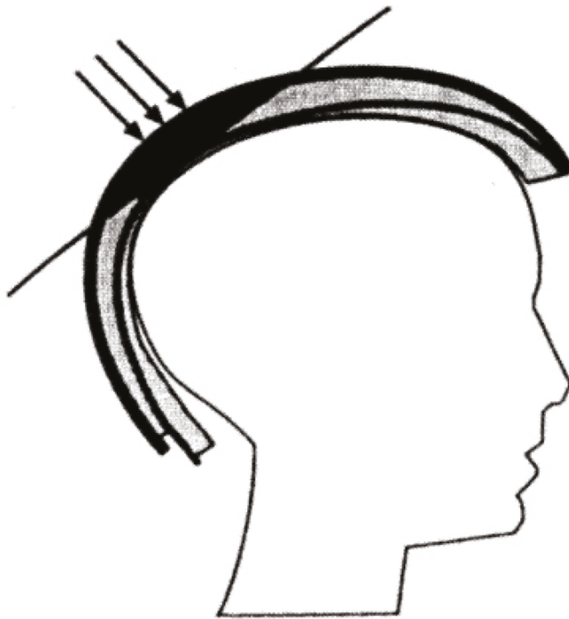
Obrázek 6.8: Deformace skořepiny helmy a výztuhy při kompresním zatížení.
