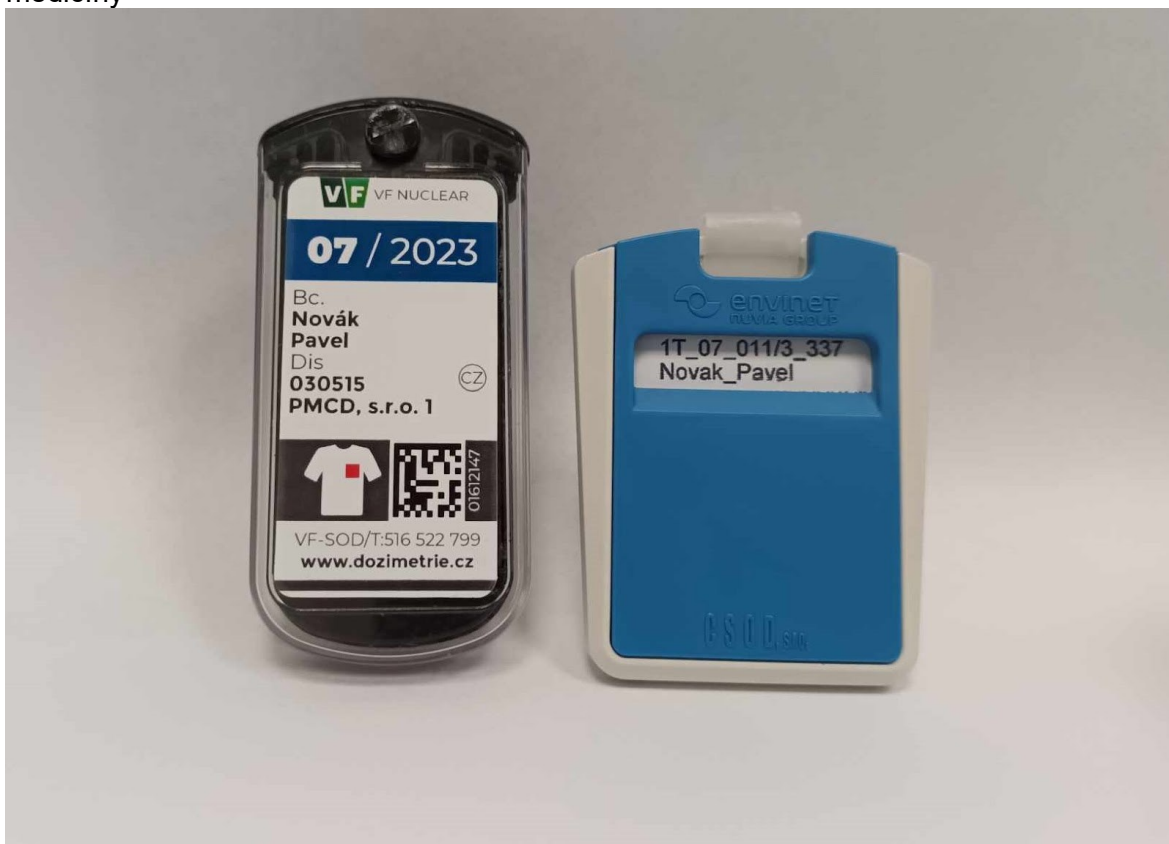
Tělové dozimetry monitorující pohlcené záření zaměstnance na oddělení nukleární medicíny
