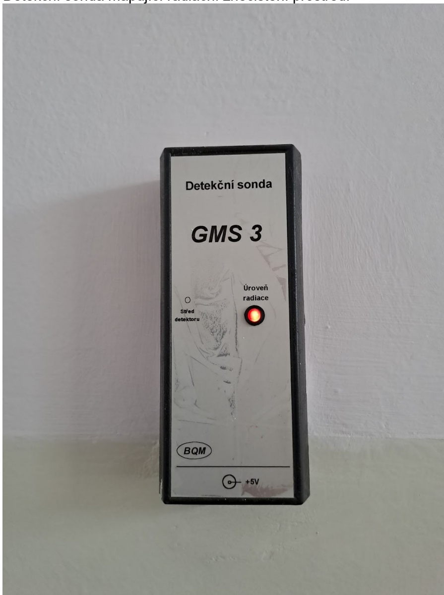
Detekční sonda mapující radiační znečištění prostředí
