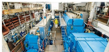
↑ Součástí dieselové lodní elektrárny jsou dva dieselové motory britské značky Rolls-Royce.
