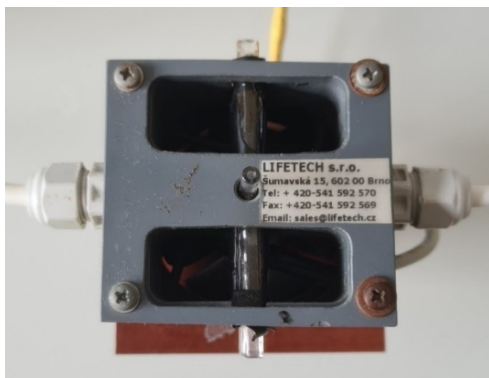
Obr. 3.2.: DBD atomizátor s lepenými elektrodami v držáku z polyvinylchloridu
