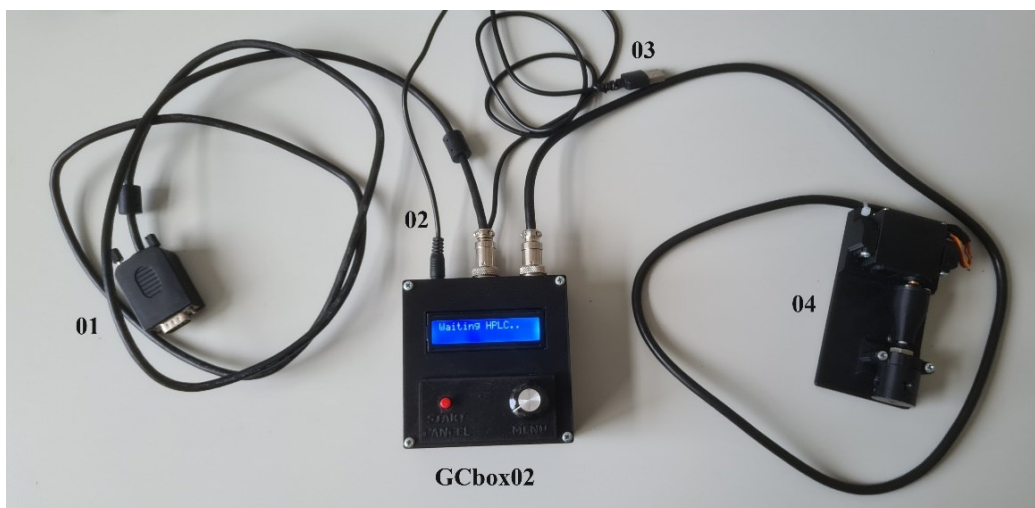
Obr. 3.3.: Kontrolní jednotka GCbox02 pro prekoncentrační měření s DBD atomizátorem (01 – sériový konektor pro propojení jednotky s HPLC, 02 – kabel pro napájení jednotky ze sítě, 03 – USB konektor pro propojení jednotky se stolním počítačem, 04 – automatický třícestný ventil pro regulaci přívodu kyslíku)
