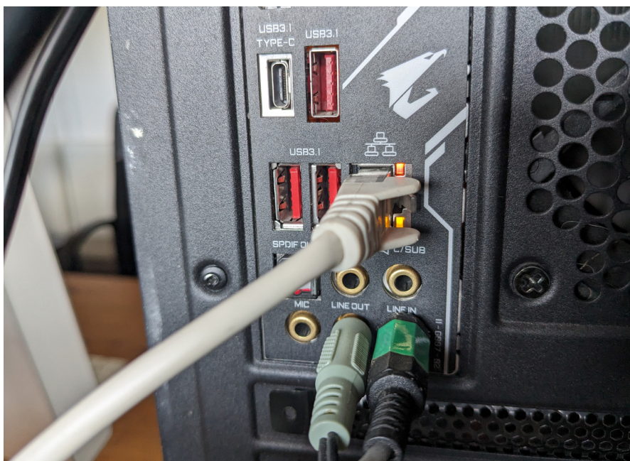
Obr. 16. Připojení výstupu kazetového magnetofonu do počítače pomocí Line IN. Foto autor
