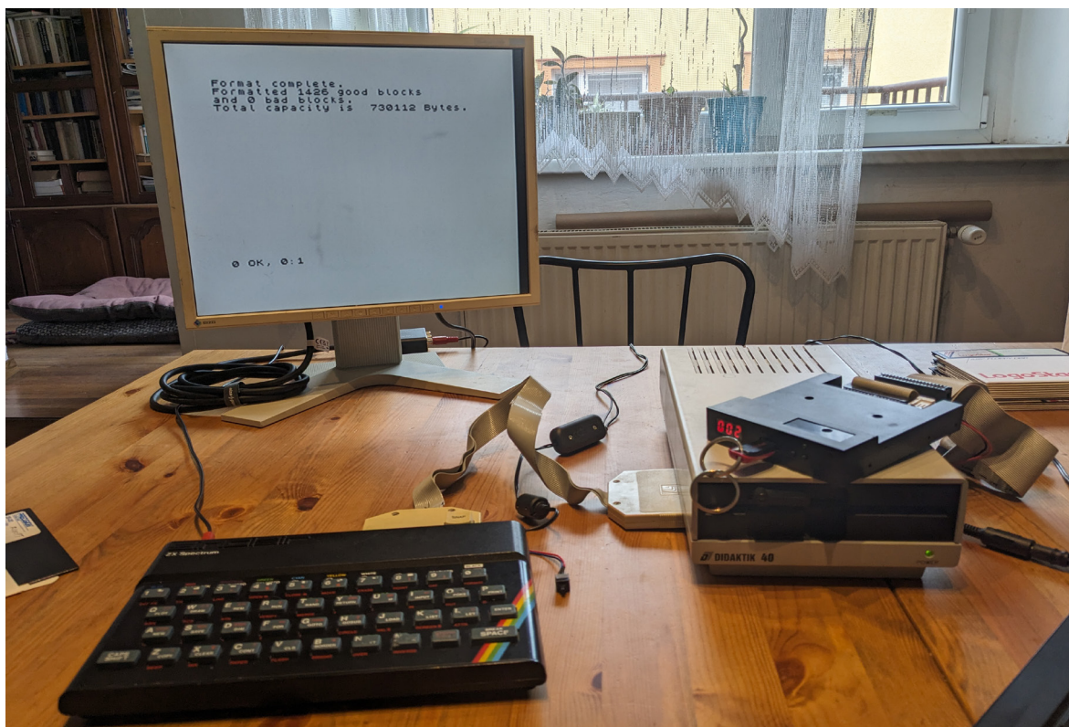
Obr. 19. ZX Spectrum s připojenou mechanikou Didaktik 40 a Gotekem. Foto autor
