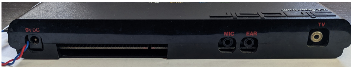
Obr. 2. Uživatelské konektory počítače ZX Spectrum. Foto autor
