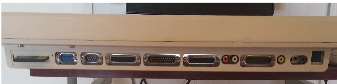
Obr. 9. Uživatelské konektory počítače Amiga 1200. Foto autor
