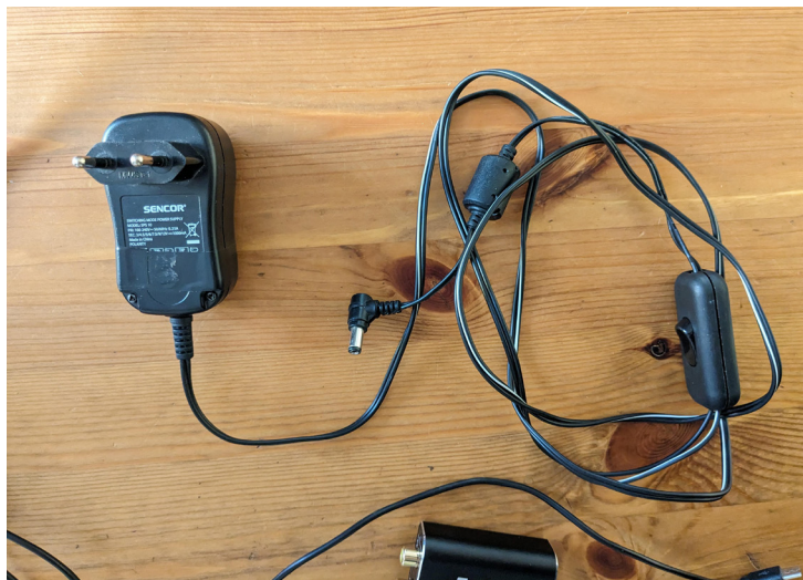
Obr. 5. Vyrobený zdroj k ZX Spectrum s vypínačem. Foto autor
