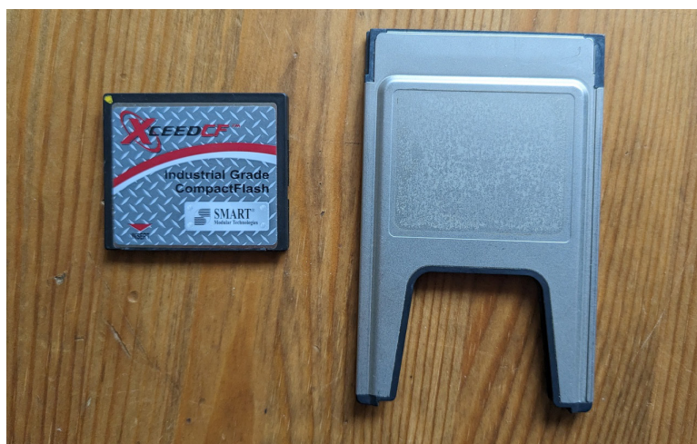
Obr. 15. Převodník CF-PCMCIA s CF kartou. Foto autor
