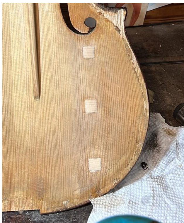
Obrázek 84 Detail opravy praskliny na rezonanční desce, Zdroj: [10]
