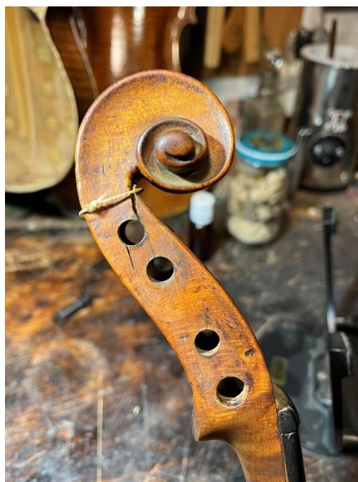
Obrázek 82 Prasklina hlavičky u A struny, Zdroj: [10]
