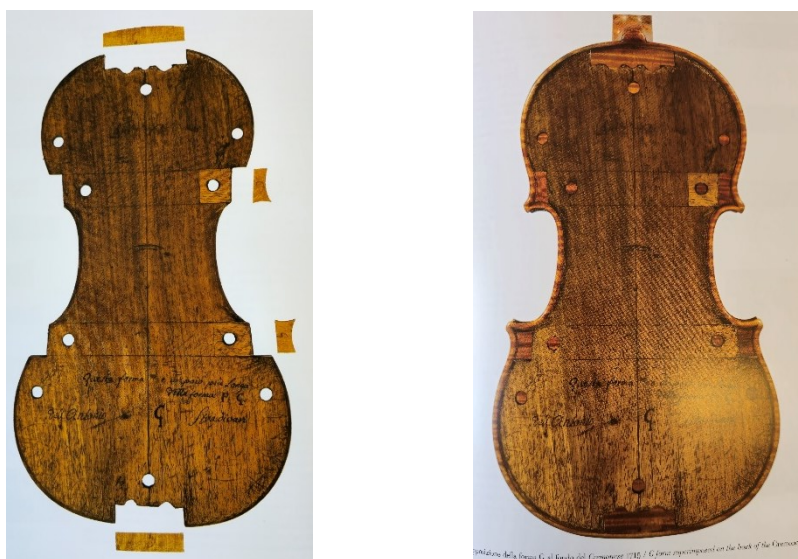
Obrázek 18 Vnitřní forma Antonia Stradivariho, Zdroj: [9]
