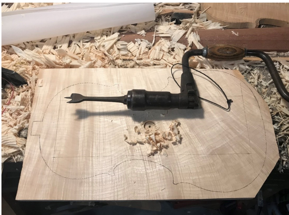
Obrázek 23 Určení hloubky klenby spodní desky vrtákem, Zdroj [10]
