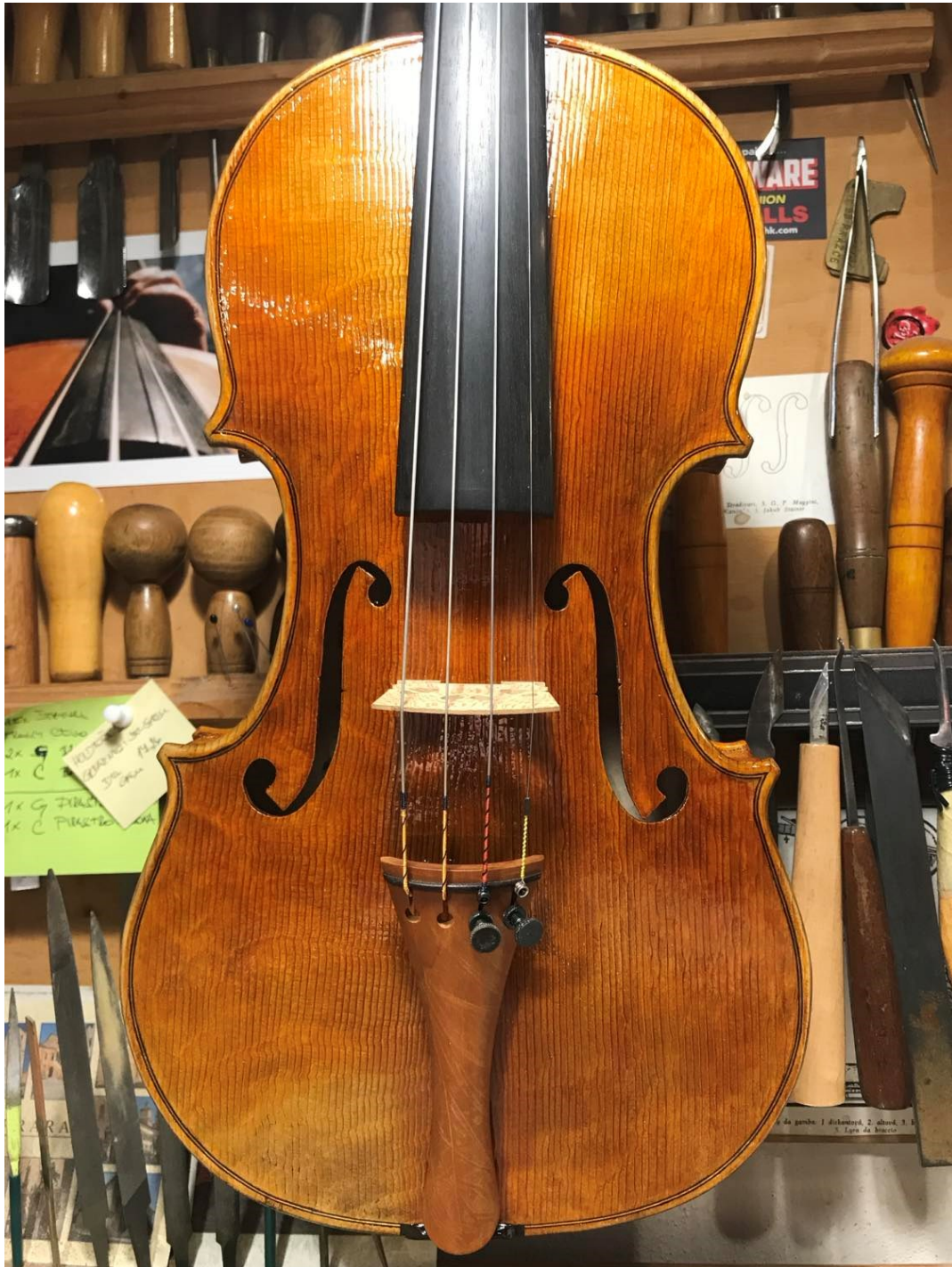
Obrázek 69 Housle po dokončení lakování, opatřené struníkem, kobylkou a strunami, Zdroj: [10]
