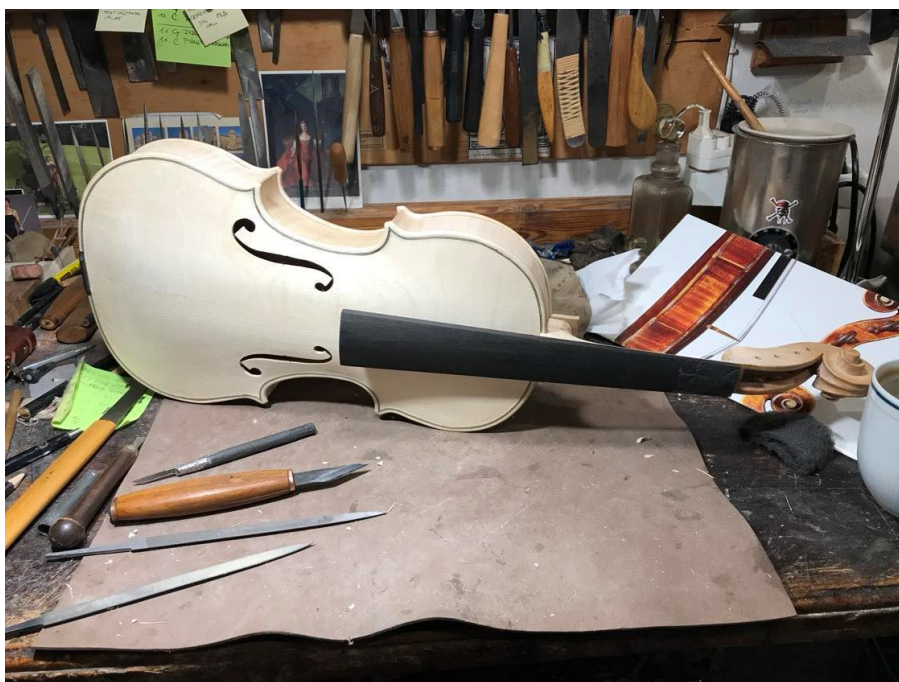
Obrázek 55 Přiklizený krk s hmatníkem, Zdroj: [10]
