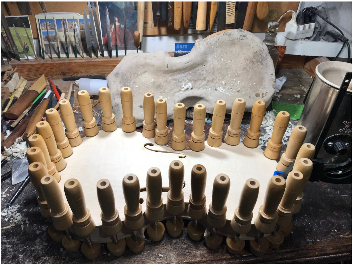
Obrázek 50 Přiklížení vrchní desky, Zdroj: [10]
