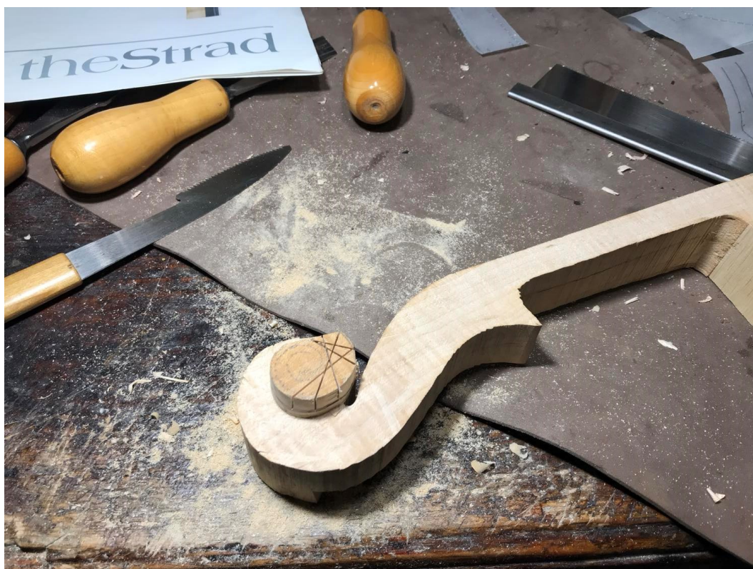
Obrázek 57 Příprava na vyřezávání hlavičky, Zdroj: [10]
