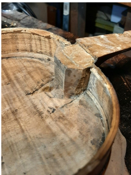
Obrázek 83 Původní, hrubě opracovaný lubový věnec, jsou vidět stopy zubatého hoblíku, Zdroj: [10]
