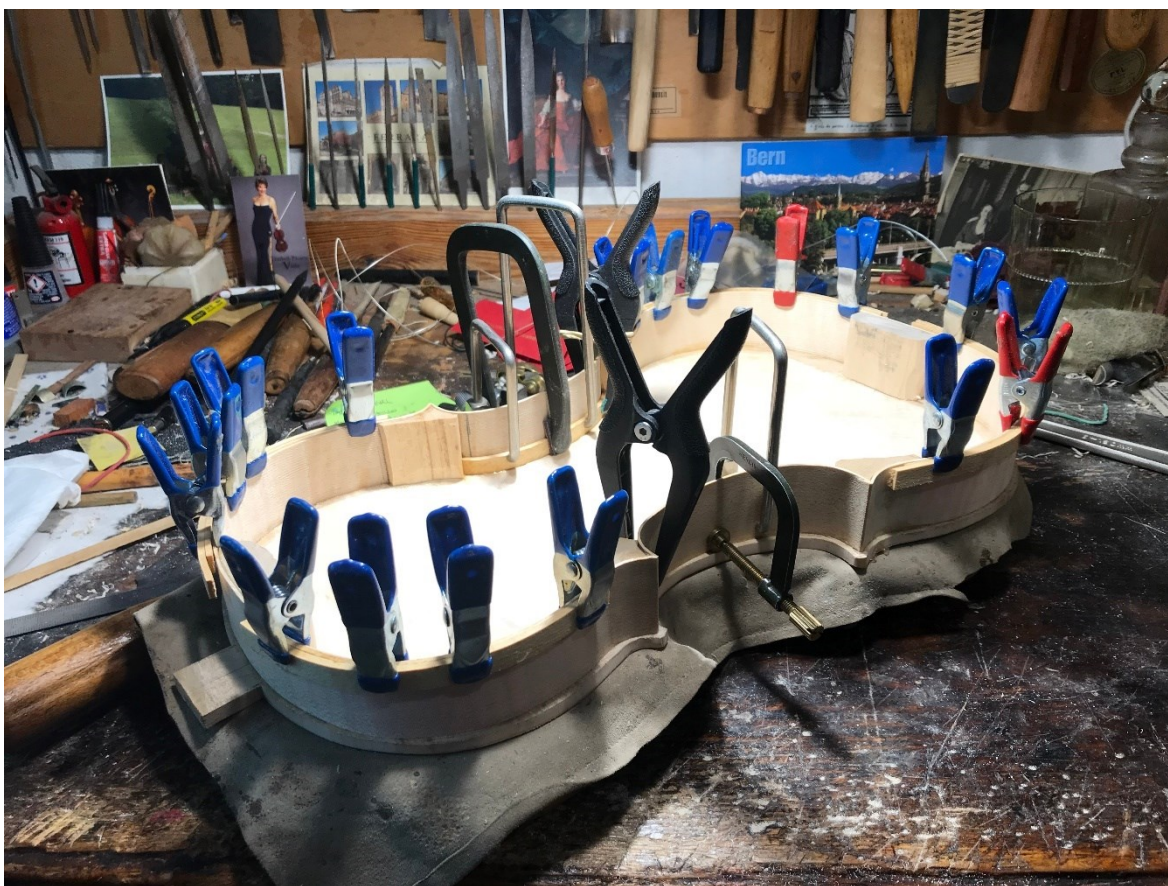
Obrázek 33 Zaklžení vnitřního olubení, Zdroj: [10]
