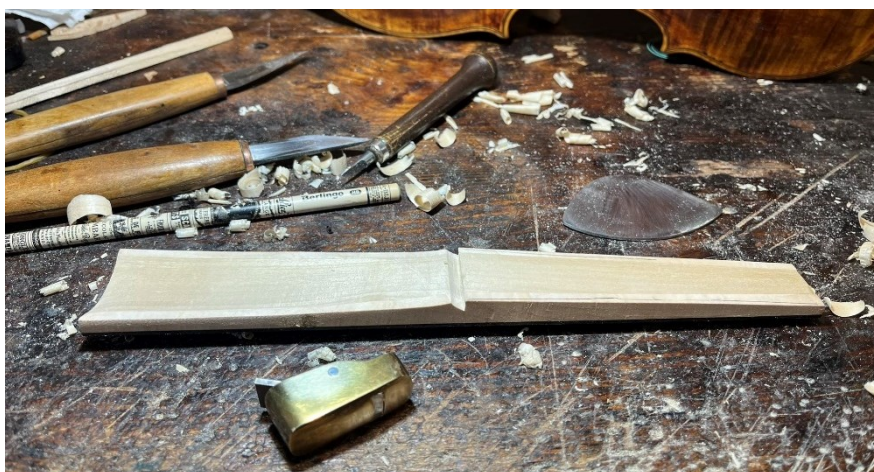
Obrázek 89 Výroba hmatníku, Zdroj: [10]
