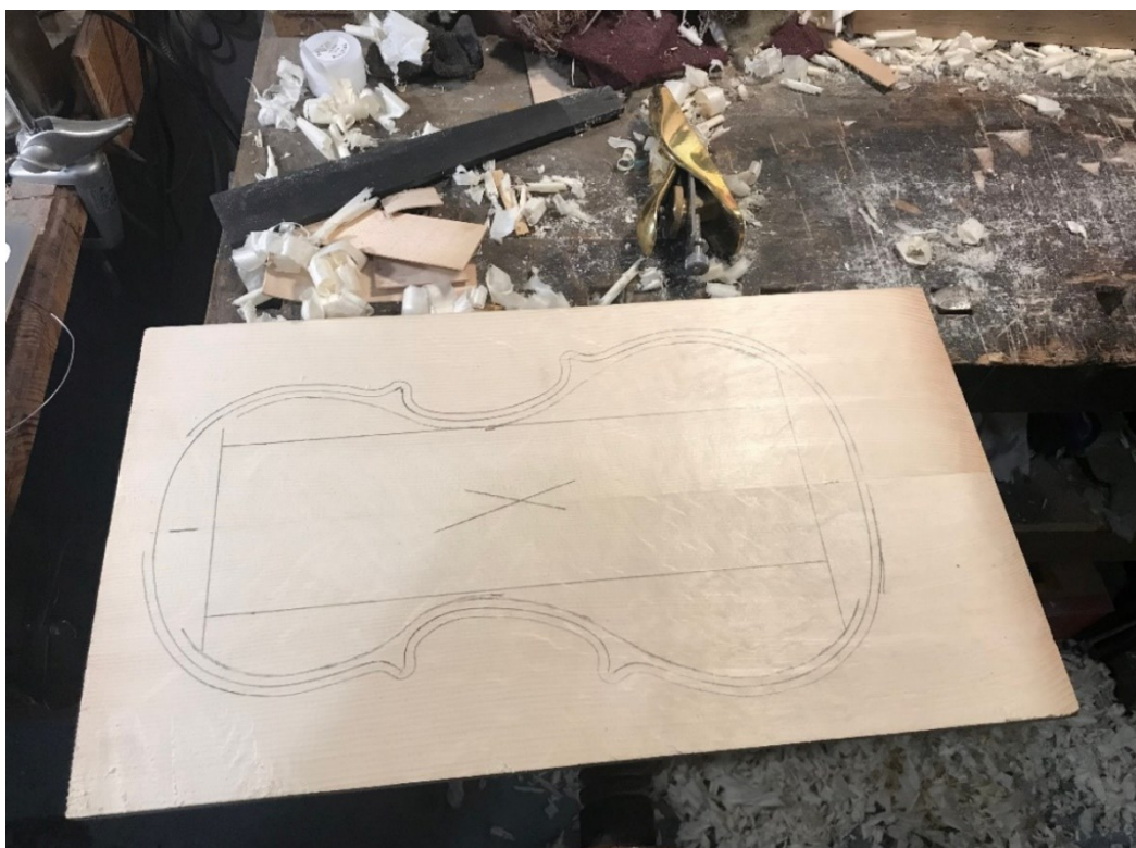
Obrázek 37 Určení akustického centra desky, Zdroj: [10]
