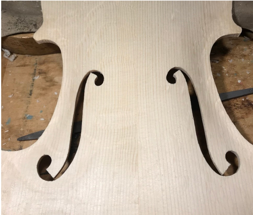
Obrázek 42 f otvory po vyříznutí, Zdroj: [10]
