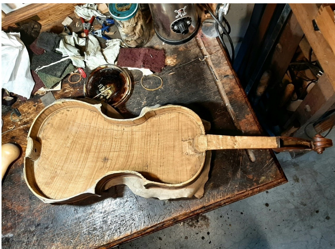
Obrázek 81 Korpus houslí po sejmutí rezonanční desky, můžeme vidět i vnitřní olubení a vypracované růžky, Zdroj: [7]
