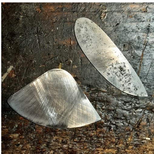
Obrázek 46 Cydliny pro začistění desek, Zdroj: [7]
