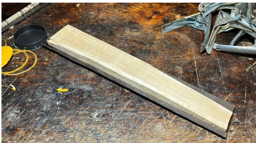
Obrázek 90 Výroba hmatníku, Zdroj: [10]
