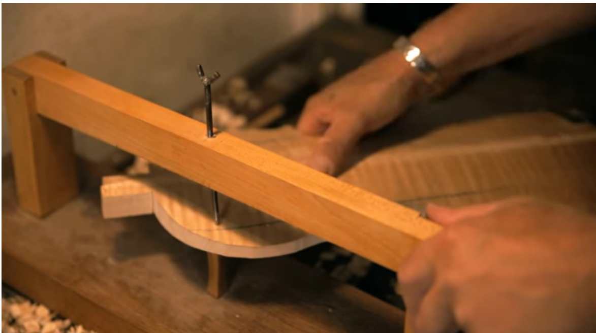
Obrázek 26 Kopírovací rastr pro přenesení klenby, Zdroj: [6]
