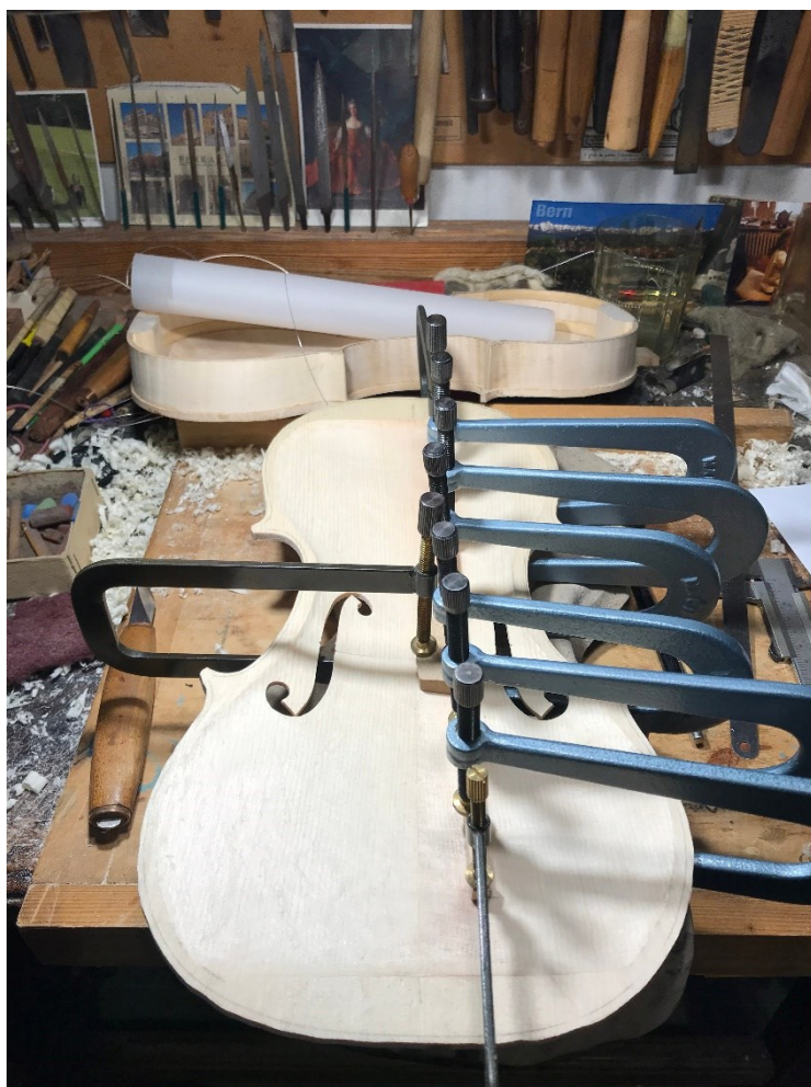
Obrázek 44 Klížení basového trámce, Zdroj: [10]
