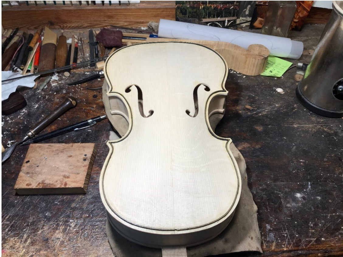
Obrázek 51 Zaklžení výložek, Zdroj: [10]
