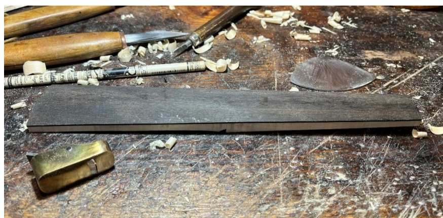
Obrázek 91 Potažení hmatníku ebenovým plátkem, Zdroj: [10]
