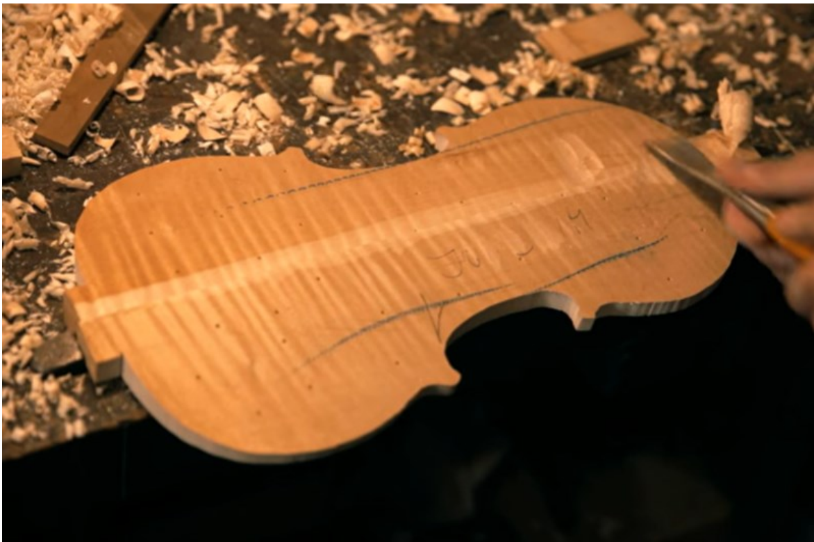
Obrázek 27 Viditelné dírký po přenesení klenby rastrem, Zdroj: [6]
