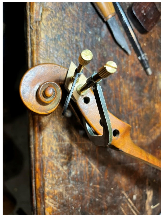
Obrázek 87 Oprava hlavičky houslí, Zdroj: [10]
