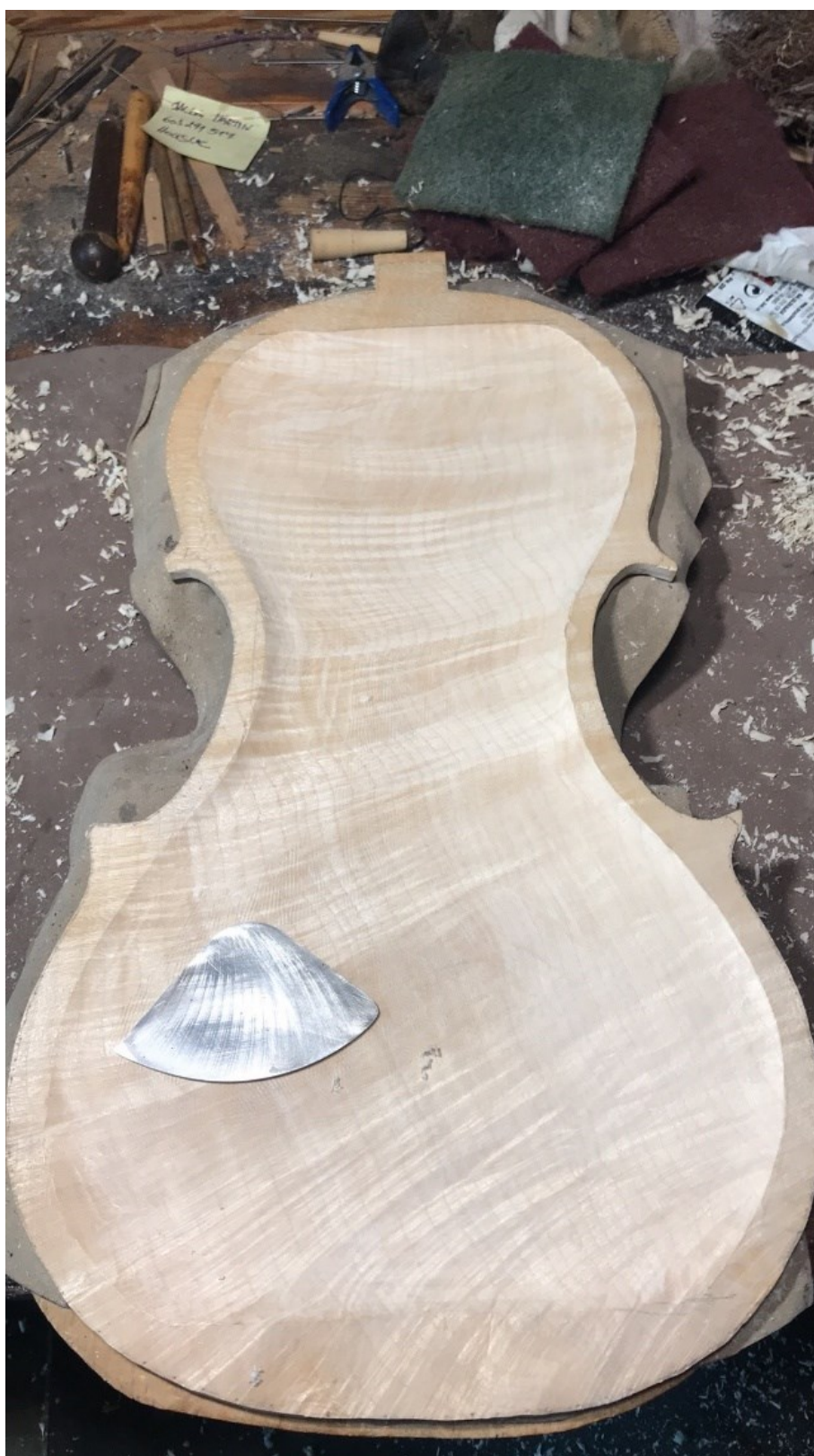
Obrázek 28 Spodní deska po dokončení, Zdroj: [10]
