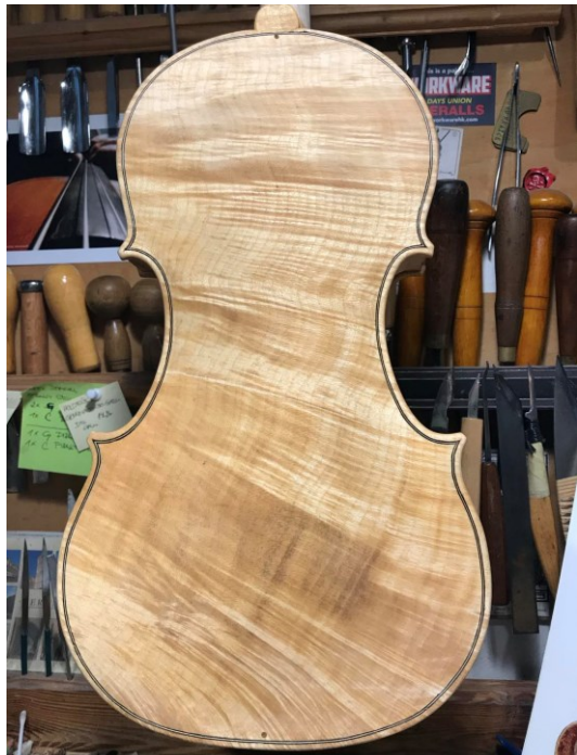
Obrázek 64 Nástroj po nanesení gruntu, Zdroj: [10]
