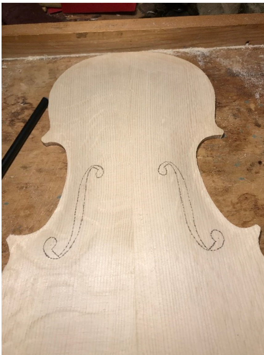
Obrázek 40 Předkreslení f otvorů, Zdroj: [10]
