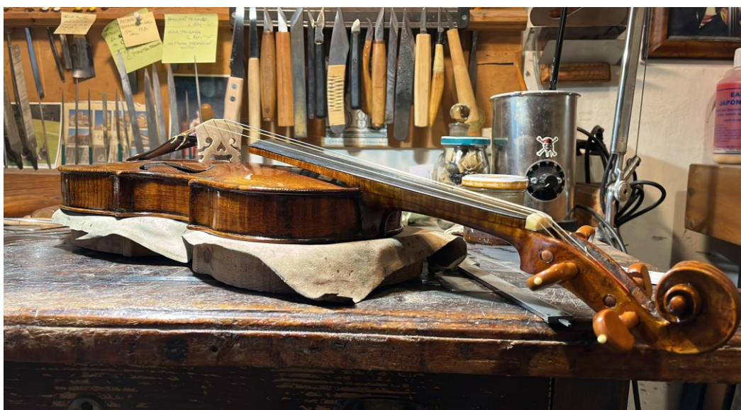
Obrázek 94 Nástroj opatřený kobyolkou "Toscani", struníkem a strunami, Zdroj: [10]
