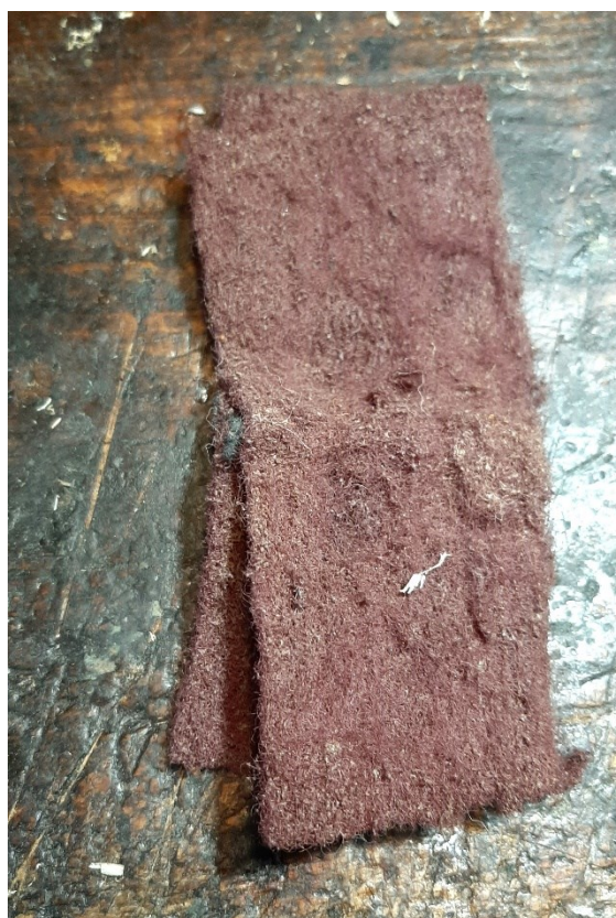
Obrázek 48 Brusné vlákno na bázi koňských žíní, Zdroj: [7]
