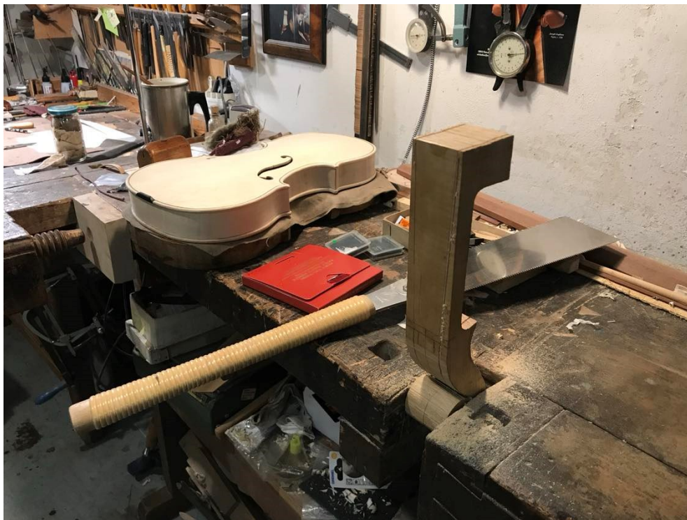
Obrázek 53 Vyříznutí krku s hlavicí z javorového bloku, Zdroj: [10]
