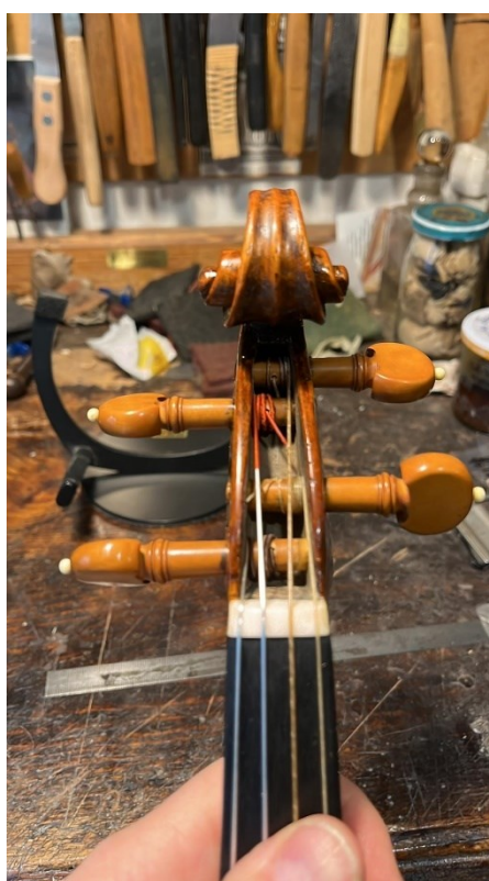
Obrázek 93 Detail hlavičky, kostěný pražec, Zdroj: [10]
