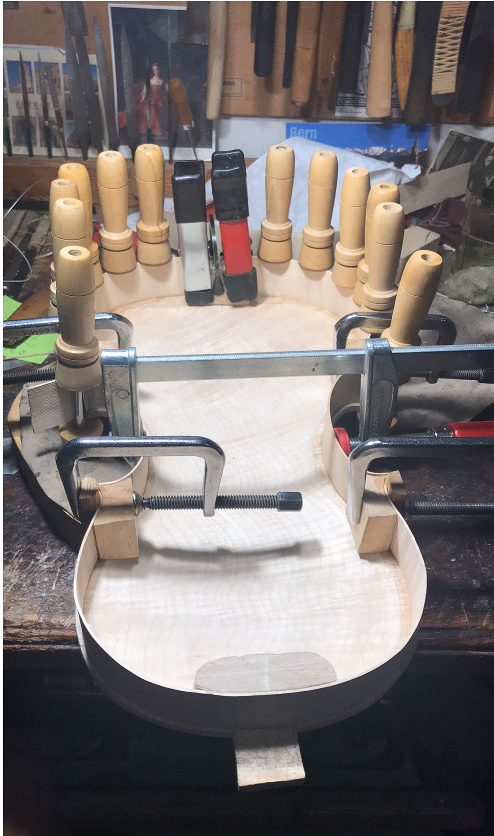
Obrázek 32 Zaklížení lubového věnce na spodní desku, Zdroj: [10]
