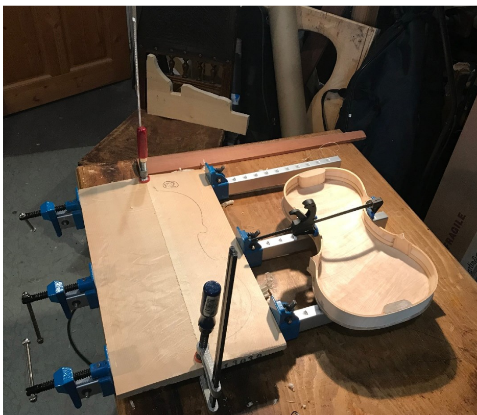
Obrázek 36 Klížení smrkových klínů, Zdroj: [10]
