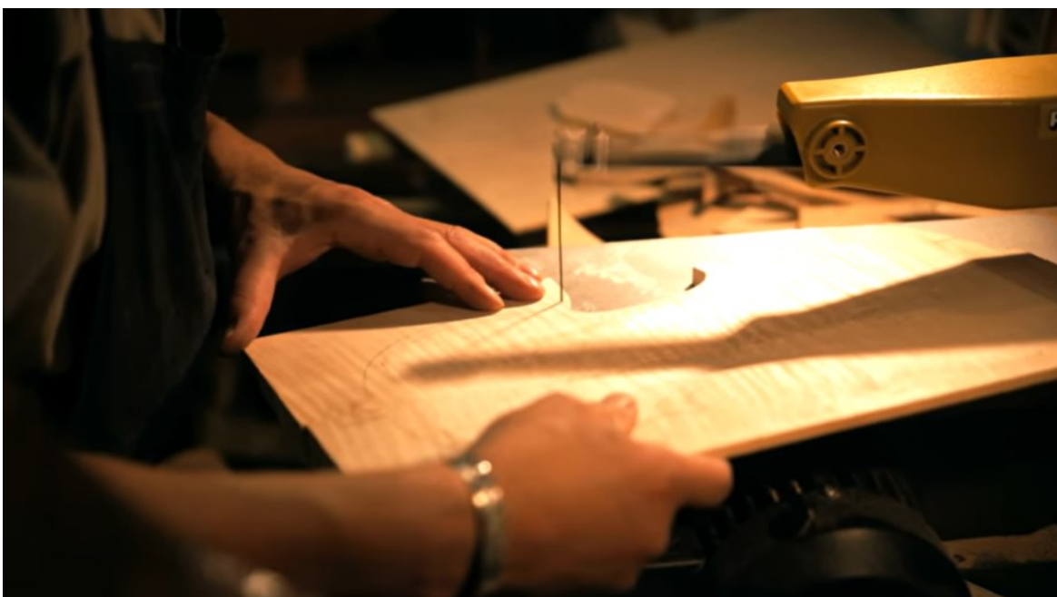
Obrázek 21 Vyřiznutí spodní desky, Zdroj: [6]
