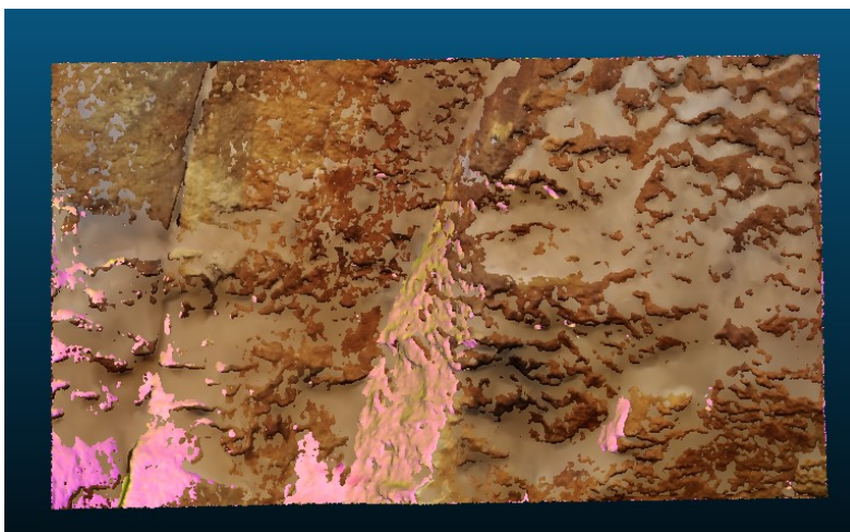
Obrázek 15 obdélníkový výřez z 3 meshe. Růžově je zobrazeno Lidarové měření, světle hnědá je březnové měření a okrově je zobrazeno únorové měření z UAV dat
