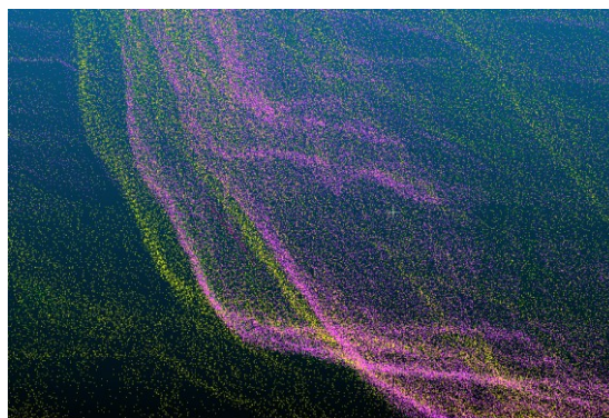
Obrázek 23 dvě hrany ve výsledném LiDARovém bodové mračně jako důsledek nepřesné registrace .
