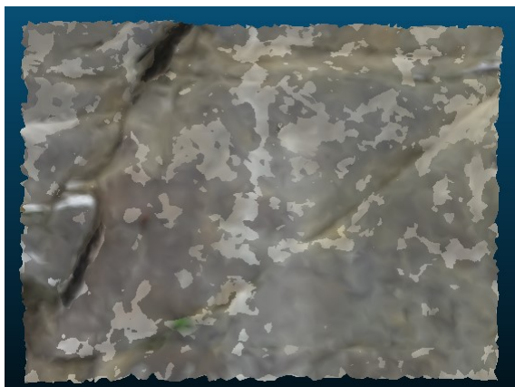
Obrázek 14 obdélníkový výřez z lomu V Doubí, světle je DMR z 22.5 a tmavě DMR z 12. 1.
