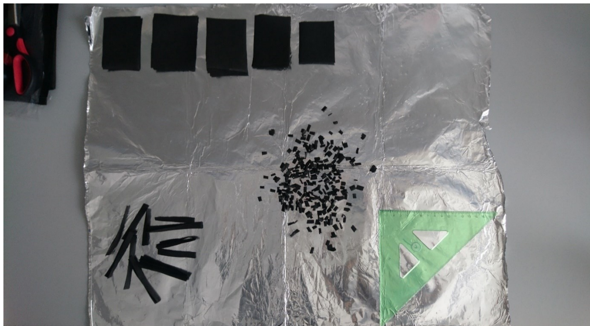
Obrázek 4 Fotografie postupu ručního stříhání mulčovací textilie na částechky zhruba o velikosti 5 x 5 mm, foto: autor.
