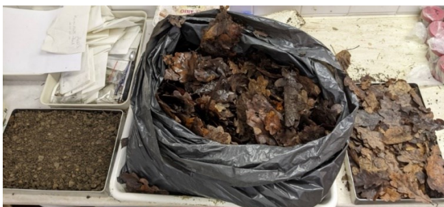
Obrázek 15 - Zakládání krabiček simulujících profil vyvinuté půdy u listnatých druhů porostu. V krabičce vlevo je rozvrstven příslušný typ homogenizované půdy. Na tuto vrstvu je v krabičce vpravo přidán daný druh opadu.
