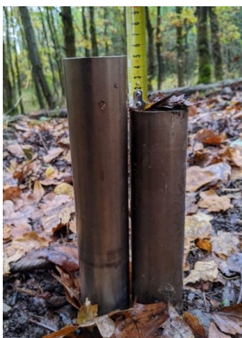
Obrázek 11 – Znázornění odběru vzorku na stanovení teploty bodu vzplanutí a hoření. Válec vpravo je téměř plný a je naposledy zatlučen do hloubky 5 cm půdního profilu. Vedle něj je pro porovnání položen prázdný, nezatlučený válec.
