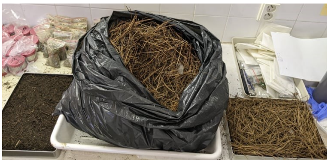
Obrázek 14 - Zakládání krabiček simulujících profil vyvinuté půdy u jehličnatých druhů porostu. Do krabičky s příslušnou homogenizovanou půdou a fermentační vrstvou (krabička vlevo) rozprostřena vrstva daného opadu. Vpravo je krabička s již přidáním opadem.
