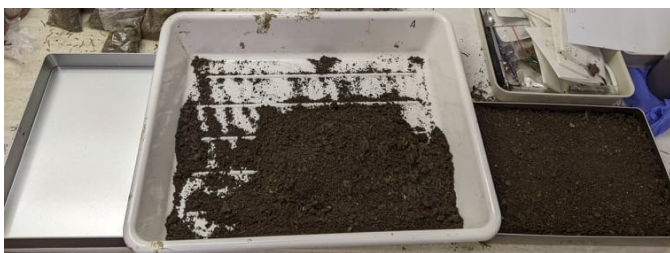
Obrázek 12 - Zakládání krabiček simulujících profil vyvinuté půdy u jehličnatých druhů porostu. Do prázdné krabičky přidána příslušná homogenizovaná půda (která je již rozvrstvena v krabičce vpravo).
