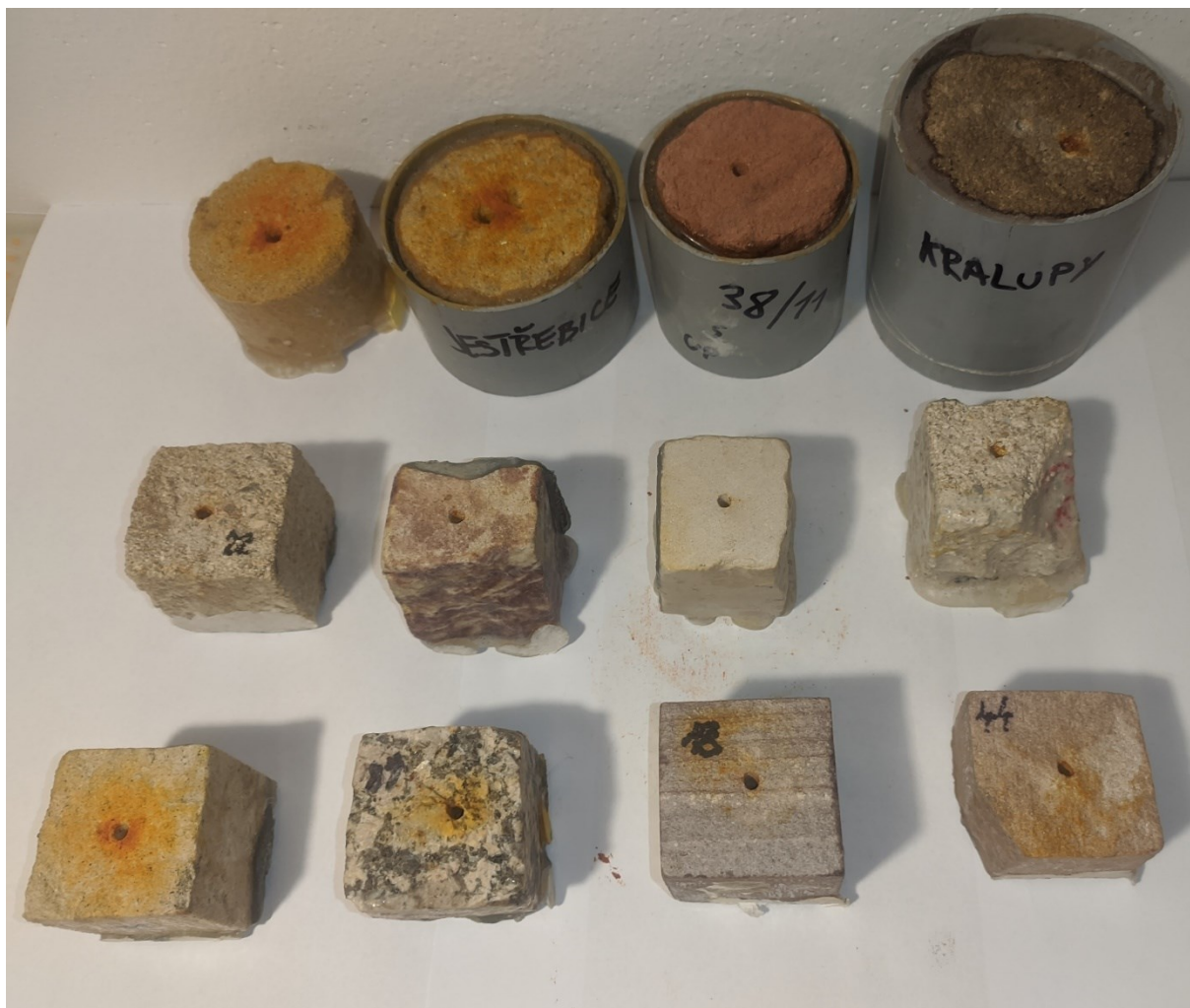
Obr. 5: Přehled dvanácti horninových vzorků použitých pro měření hloubky výparové fronty a intenzity výparu. K výparu docházelo pouze jejich svrchní podstavou. Díra uprostřed každého vzorku sloužila pro vkládání uraninové sondy do vzorku.
