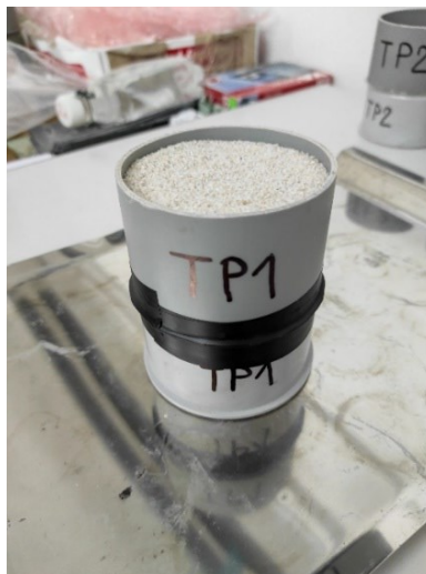
Obr. 16: Wetcup TP1 s křemenným pískem. Ukázka prvního vytvořeného prototypu wetcupu s nasypaným pískem. Zde se jedná pouze o ukázkou, písek v tomto případě není zcela dosypán až po okraj svrchní části nádoby. Ve spodní části se nachází rezervoár na vodu. Černá elektrikářská páska překrývá spoj spodní a svrchní části nádoby se sítkou. Pro případ měření byl takový wetcup dosypán pískem zcela po okraj.
