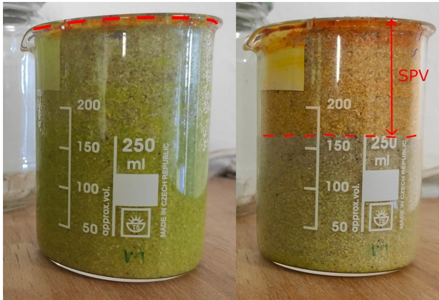
Obr. 12: Ukázka dvoufázového rozdělení z průběhu experimentu č. 5 s použitím roztoku fluoresceinu sodného. Červená přerušovaná linie vyznačuje úroveň výparové fronty v příslušné fázi. SPV – vyznačuje oblast suché přípovrchové vrstvy. Bílý papír přelepený průhlednou izolepou slouží k zabránění nerovnoměrnému postrannímu vypařování v okolí ústí kádinky.
