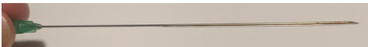
Obr. 6: Medicínská jehla s naneseným polyuretanovým lepidlem připravena k obalení do uraninu.
