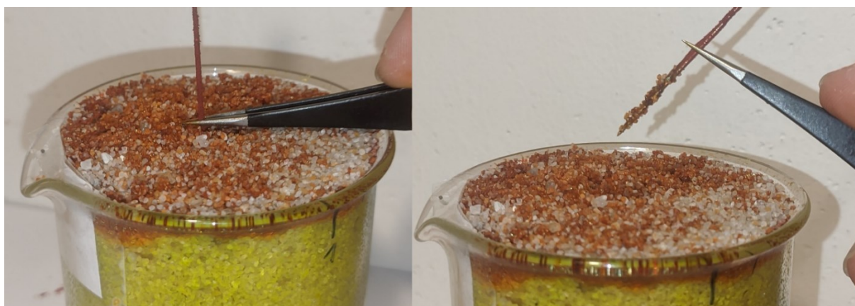
Obr. 10: Vlevo je ukázka vložené jehlové sondy do kádinky s pískem. K připravené jehlové sondě k vyjmutí je těsně k povrchu přiložená pinzeta. Vpravo je již pinzetou vyjmutá jehlová sonda s naměřenou výparovou frontou.
