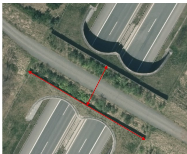
Obr. 4: Měření ekoduktu Sezimovo Ústí s rovinným tvarem.
