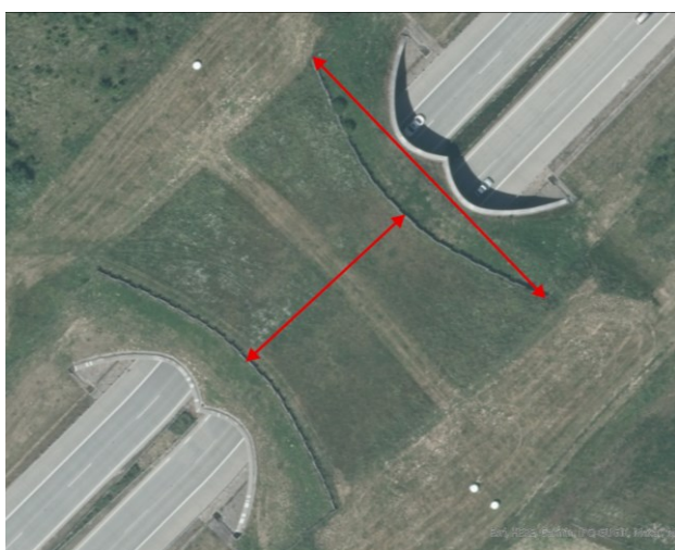
Obr. 3: Měření ekoduktu Kletné s nálevkovitým tvarem
