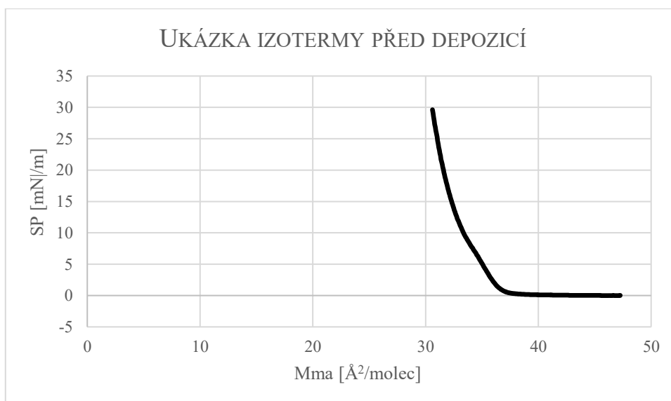
Graf 5: Ukázka izotermy naměřené před depozicí směsi na substrát – NS Model 2-I.
