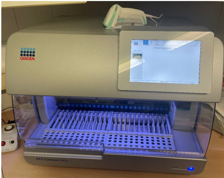
Obrázek 15. Izolátor DNA pro zpracování vzorků na vyšetření metodou PCR. (Zdroj: Vlastní)
