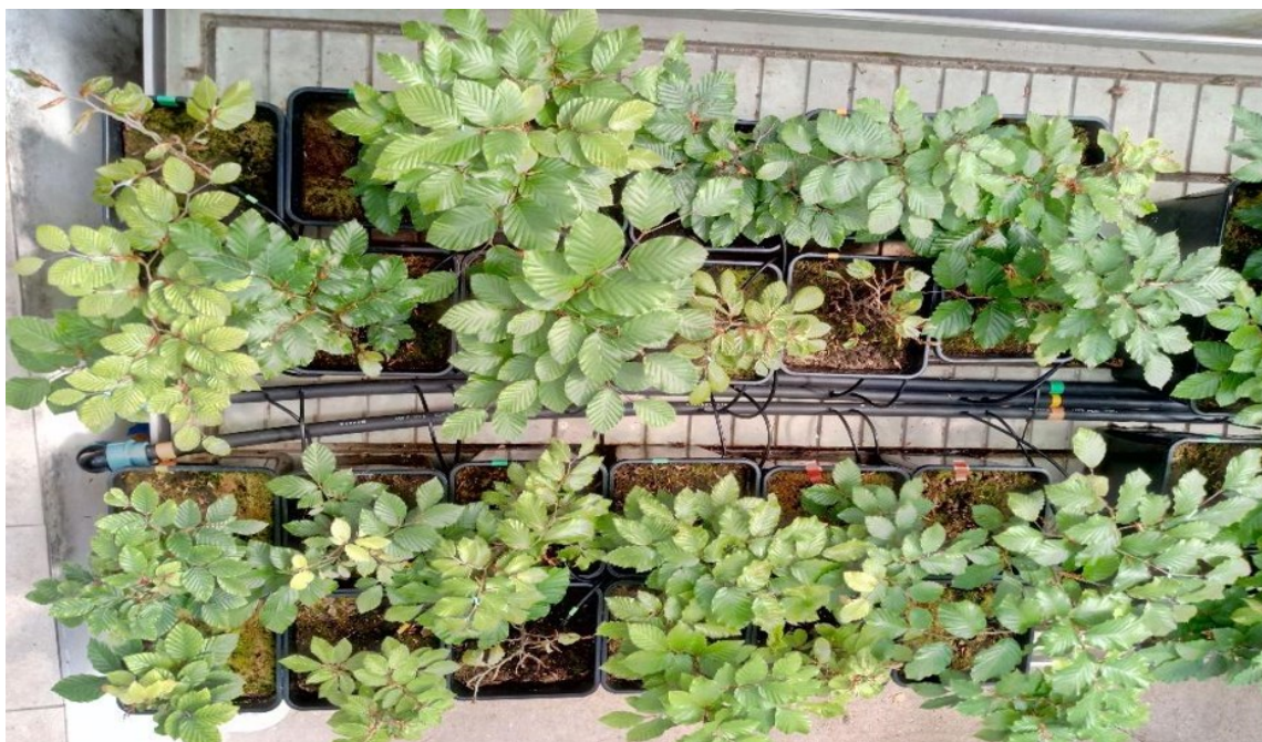
Obrázek č. 12: Celkový pohled na třetinu experimentálního systému; z větví zavlažovacího systému vycházejí hadičky zakončené jehlami, které zajišťují zásobování jednotlivých květináčů vodou. Foto E. Neuwirthová.
