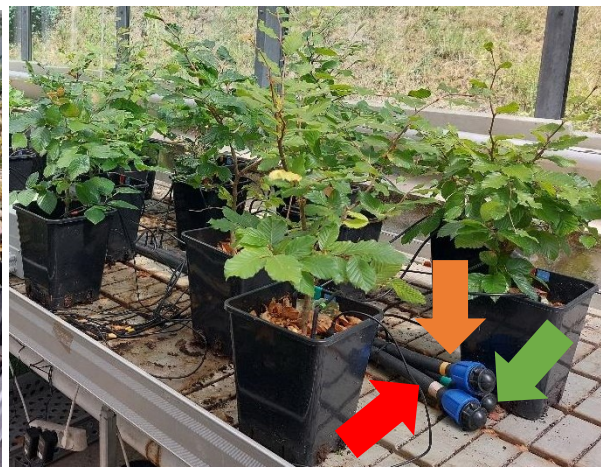
Obrázek č. 11: Větvě zavlažovacího systému (označeny šipkami – barevné značení odpovídá barevnému značení ošetření: zelená = kontrola, oranžová = mírné sucho, červená = sucho) na obou stranách experimentálního systému – připojení ke zdroji vody (a; fotografováno na konci vegetační sezóny 2021), slepé zakončení (b; fotografováno po reorganizaci porostu v průběhu sezóny 2022). Foto O. Červenka.
