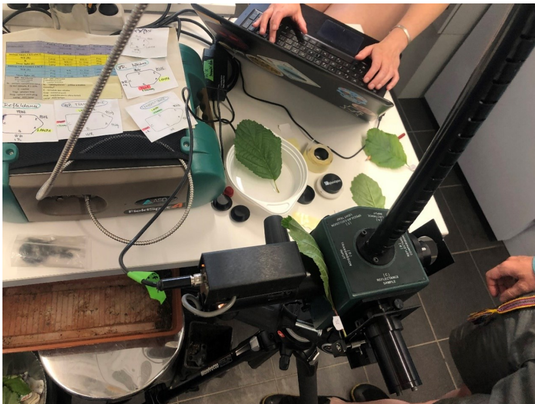
Obrázek 14: Měření optických vlastností listů olše lepkavé za použití integrační sféry.
