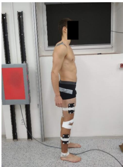
Obrázek 12: Umístění reflexních markerů (zdroj: Krajcigr, 2022)
