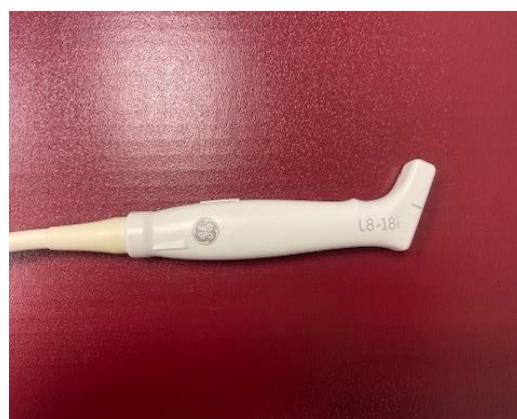
Obrázek 4 - Hokejková sonda Logiq L8-18i s frekvenčním rozsahem 5-15 MHz, která byla používána pro zobrazení vazů [zdroj: archiv autora]
