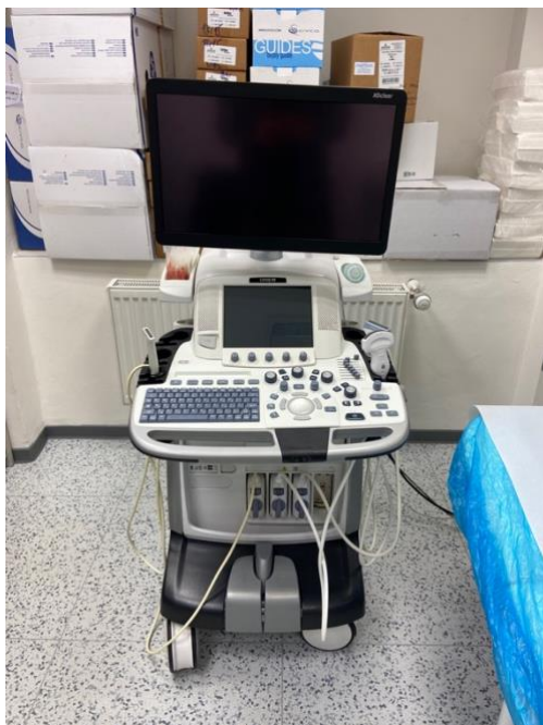
Obrázek 5 - Logiq E9 XD Clear 2.0 využívaný při vyšetření v naší práci [zdroj: archiv autora]
