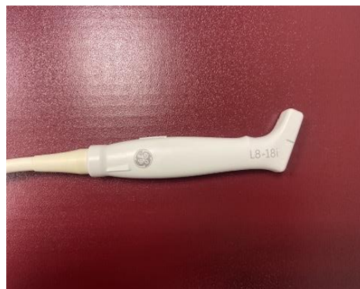
Obrázek 4 - Hokejková sonda Logiq L8-18i s frekvenčním rozsahem 5-15 MHz, která byla používána pro zobrazení vazy [zdroj: archiv autora]
