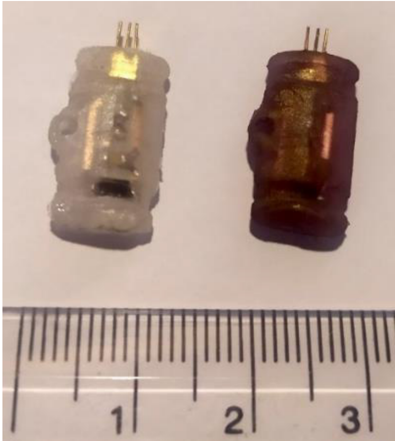
Obr. 29: Enkapsulované vzorky implantabilních zařízení
