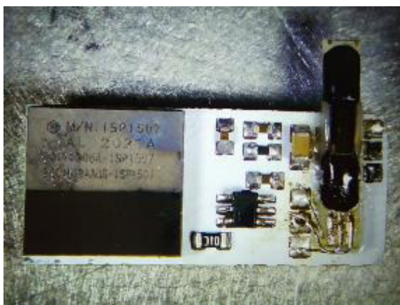
Obr. 22: Způsob připojení pH senzoru k zařízení
