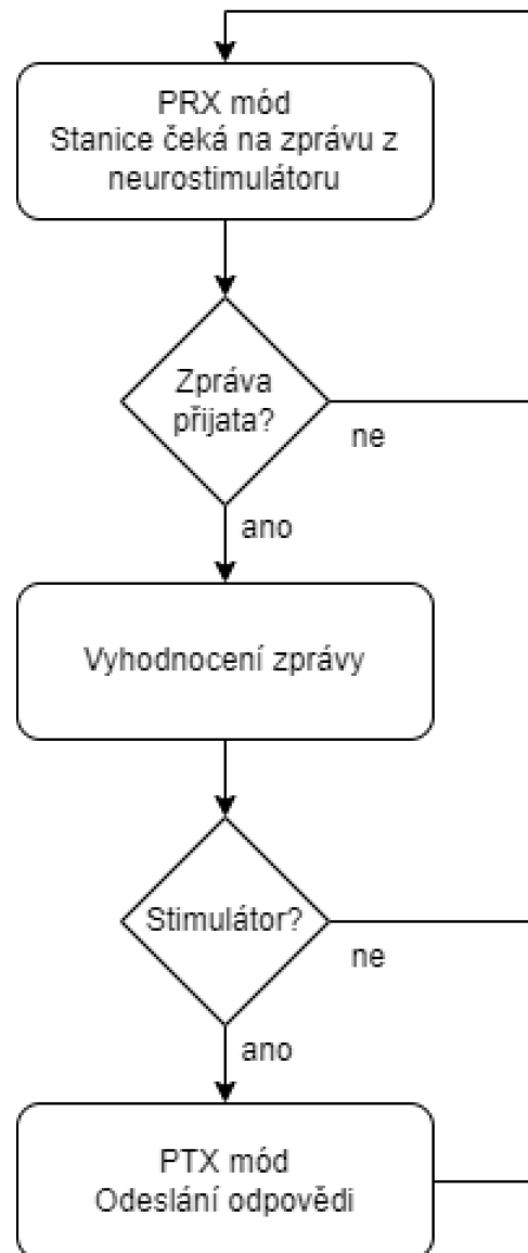
Obr. 3: Stavový automat externí stanice
