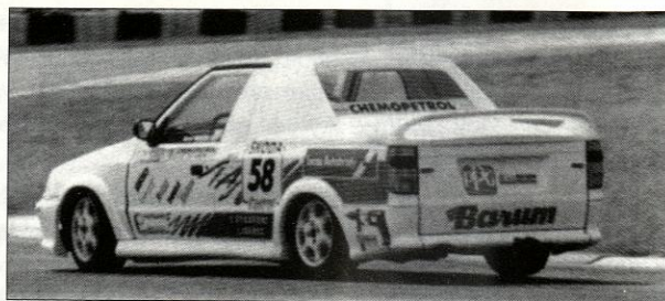
Kryt ložné plochy okruhových pick-upů byl přišroubován ke karoserii
