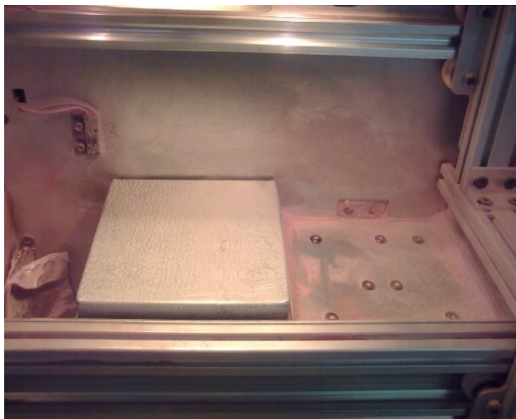
Obrázek č. 5: Hliníková krabička vložená do tiskové komory
