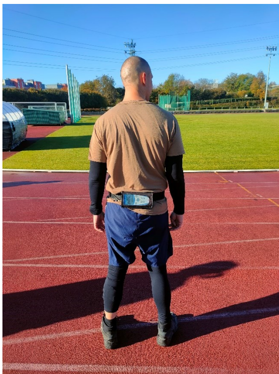
Obrázek č. 5: Proband ve vojenské obuvi, s přístrojem Biomonitor ME6000, připravený k měření
