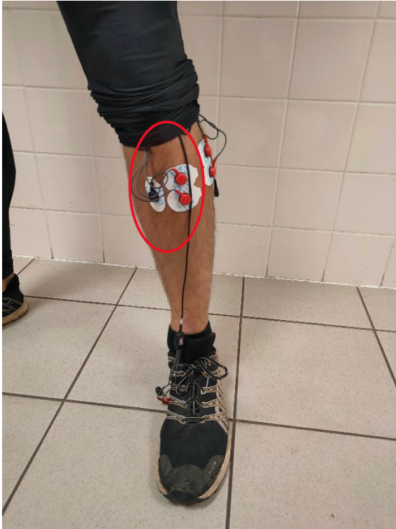
Obrázek č. 1: Elektrody snímající svalovou aktivitu m. tibialis anterior
