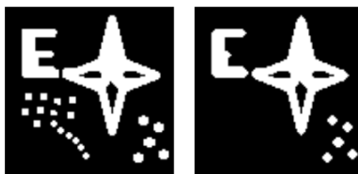
Obr. 4.3 Vľavo je vstupný, vpravo výstupný obraz po operácii morfológického otvorenia.
