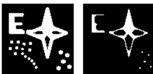
Obr. 4.2 Vľavo je vstupný obraz, vpravo erodovaný výstupný obraz.
