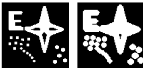
Obr. 4.1 Vľavo je vstupný obraz, vpravo dilatovaný výstupný obraz.
