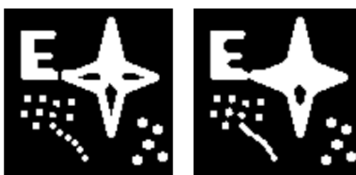
Obr. 4.4 Vľavo je vstupný, vpravo výstupný obraz po operácii morfológického uzavretia.
