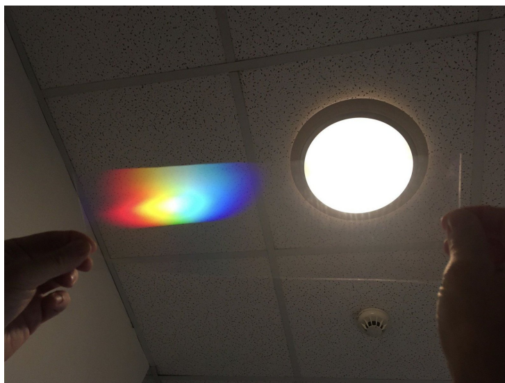
Obrázek 1.23: Ohyb světla na fólii s ohybovými vrypů
