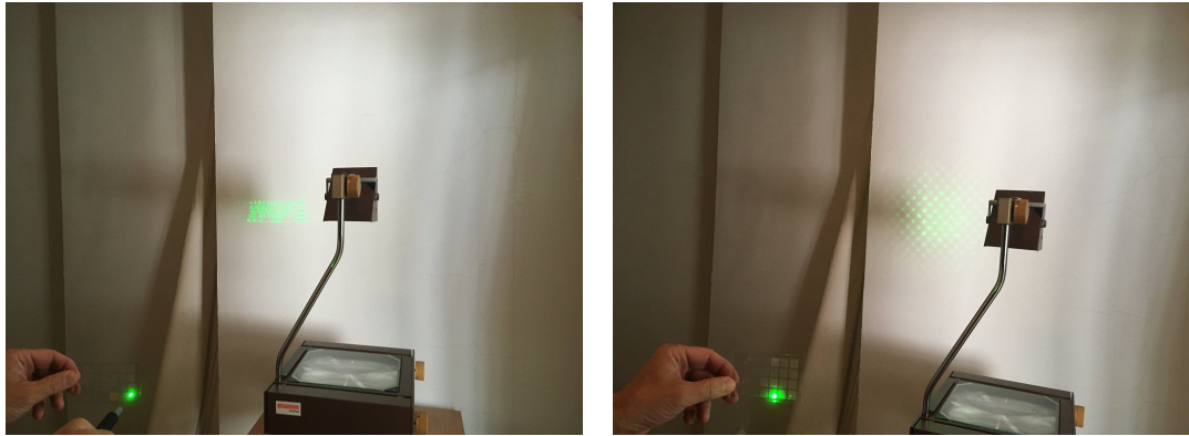
Obrázek 1.24: Difrakce na fólii s různými vrypky
