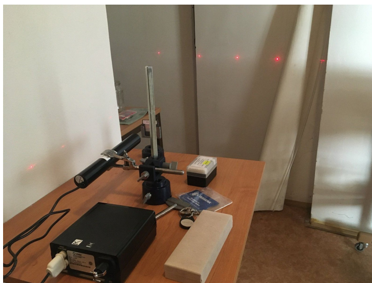
Obrázek 1.28: Experimentální uspořádání s helium-neonovým laserem
