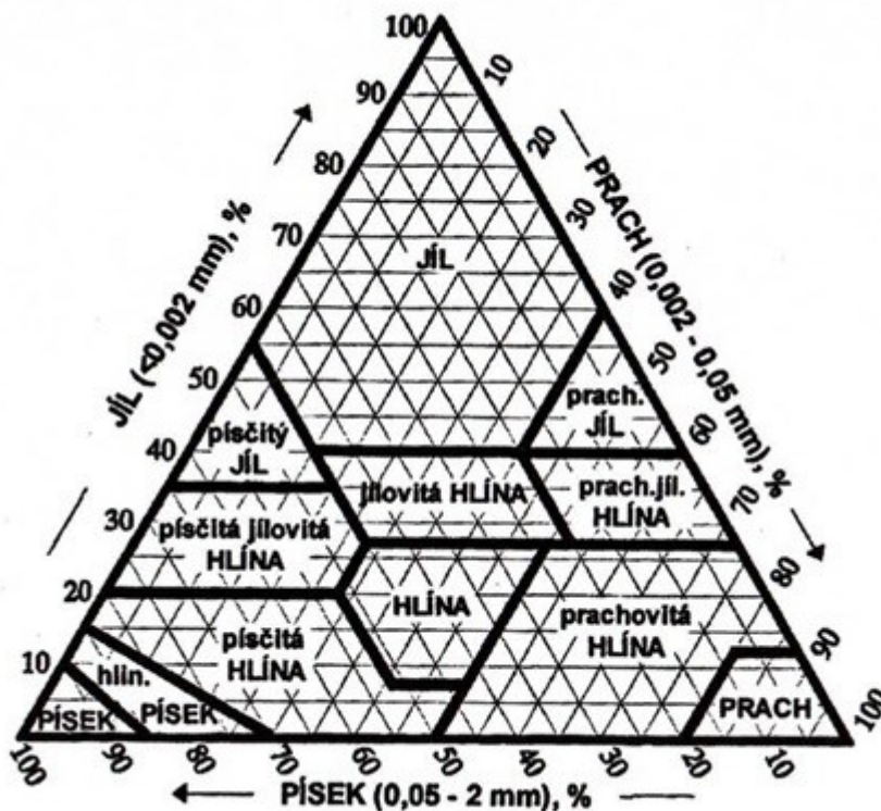
Obr. 2. Trojúhelníkový diagram zrnitosti půd (J. Němeček a kol., 2011).
