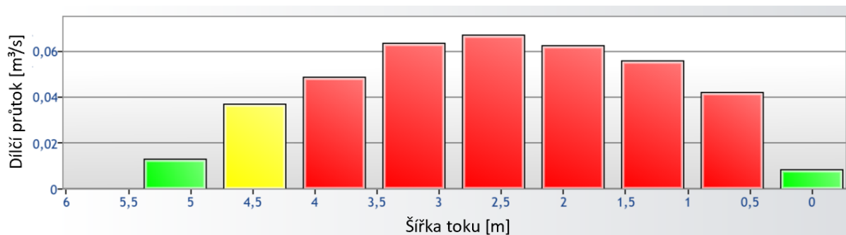
Obr. 5. Barevné rozlišení procentuálních velikostí dílčích průtoků vzhledem k celkovému průtoku. Zelená do 5 %, žlutá 5–10 % a červená nad 10 %. Výstup ze softwaru FlowTrackeru, profil Loděnice.
