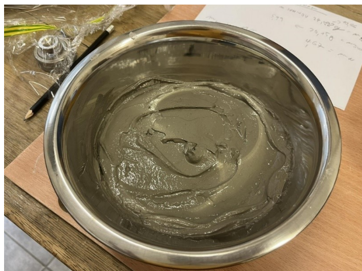
Obr. 22 - Homogenizovaný, vodou saturovaný vzorek o konzistenci pasty před oedometrickou zkouškou.
