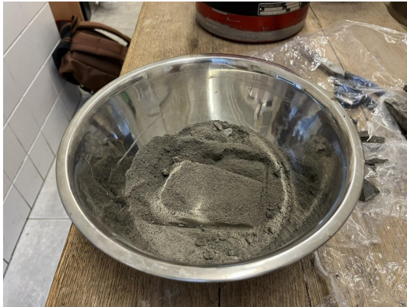
Obr. 21 - Rozdružený vzorek před zalitím destilovanou vodou.
