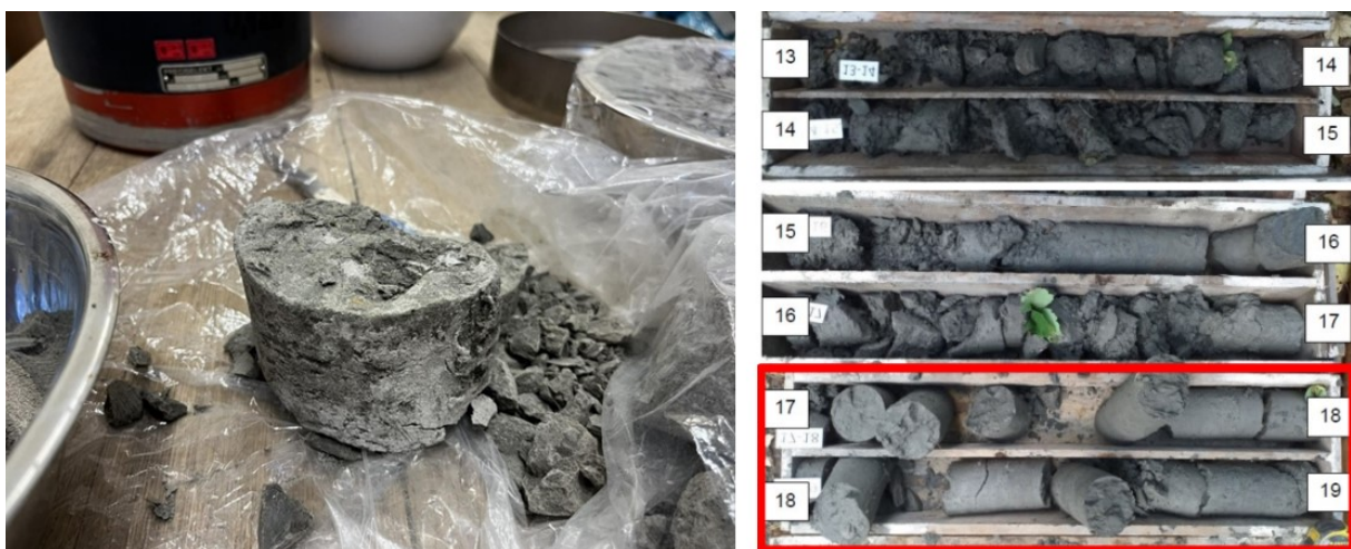
Obr. 20 – Část vrtného jádra ze sesuvného území Prackovic požitá pro laboratorní měření (vlastní fotografie) a celé vrtné jádro z vrtu INP 1009 (červeně je označen odebraný úsek jádra pro laboratorní zkoušky z hloubky 17–19 m) – (autor, Jan Jerman).
