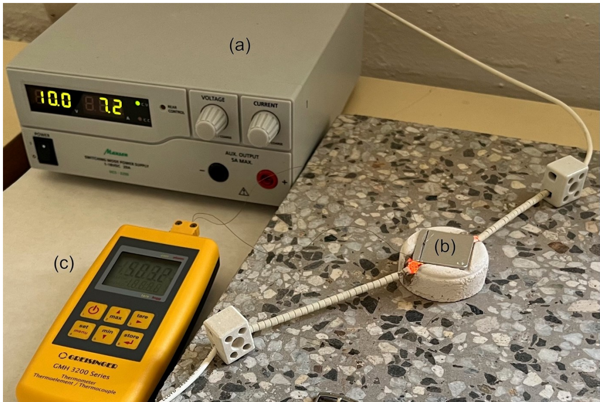
Obr. 4. Spuštěná experimentální zahřívací aparatura: (a) poloautomatický zdroj napětí; (b) hliníkový nosič vzorku s drážkou pro termočlánek (503 °C); (c) termočlánekový teploměr.
