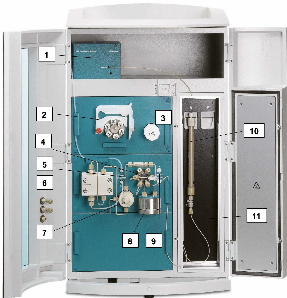
Obrázek 3 - Ionový chromatograf Metrohm 850 Professional IC Anion (převzato a upraveno z Manual for 850 Professional IC, 2.850.2010 – Anion, dostupné na https://www.metrohm.com/cs_cz/products/2/8502/28502010.html )[31], 1. vodivostní detektor, 2. peristaltické čerpadlo, 3. MSM modul (chemický supresor), 4. dávkovací ventil 5. odplyňovač mobilní fáze, 6. vysokotlaké čerpadlo, 7. promývací ventil, 8. tlumič pulsů, 9. odplyňovač vzorku, 10. separační kolona, 11. kolonový termostát
