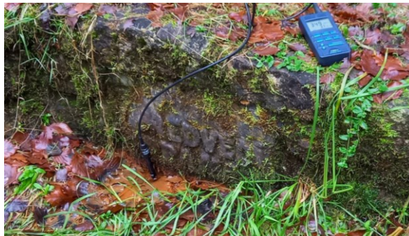
Obr. 40 - Současný stav Medvědího starého p. Nánosy železa a zvýšená elektrická vodivost indikují možnou přítomnost minerální vody (6.1.2024)
