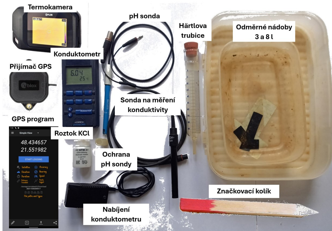
Obr. 24 - Vybavení pro terénní mapování minerálních pramenů (zdroje obrázků: promertech.sk (2024), mouser.com (2024), gpslogger.app (2024) a geoobchod.cz (2024))
