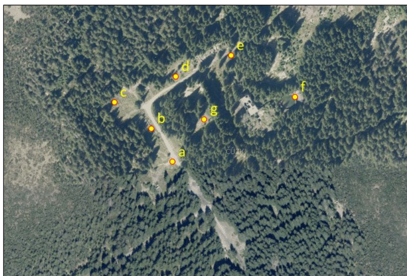
Obr. 5: Rozmístění použitých vřícovacích bodů Zdroj: Vlastní zpracování
