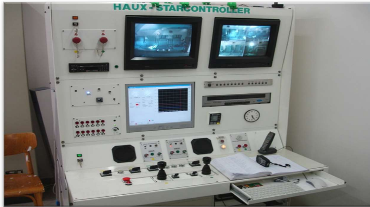
Ovládací pult barokomory (Kladno), vlastní foto
