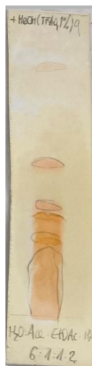
Obrázek 27: TLC podfrakce GV-6-E-0-G po důkazu Dragendorffovým činidlem
