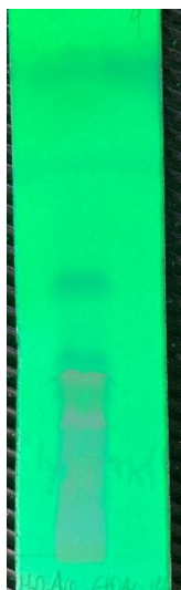
Obrázek 26: TLC podfrakce GV-6-E-0-G pod UV světlem
