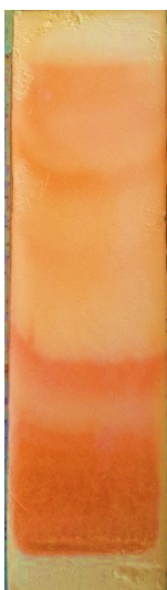
Obrázek 16: Litá deska s frakcí GV-6 vyvíjená v S_1 postříkaná Dragendorffovým činidlem
