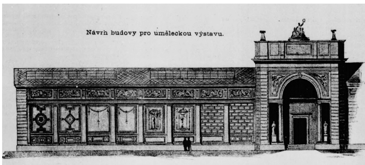
61. Pavilon pro výstavu uměleckou, Jubilejní zemská výstava 1891: Wiehlův návrh průčelí se sgrafity
