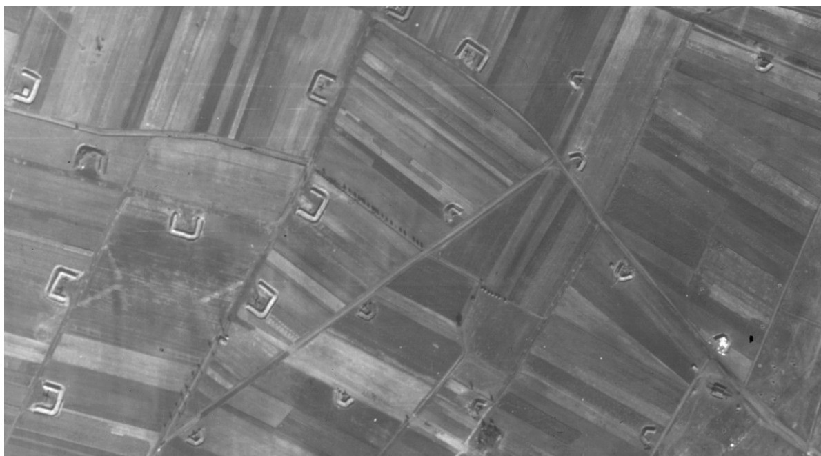
Obr. 13: Vojenské letiště Erfurt 7. 10. 1944. Rozptylové ochranné valy v ploše okolo letiště (odpovídající typu 1 – březem). Zdroj: GDI-Th, Freistaat Thüringen, www.geoportal-th.de (přístup 13.8.2024).
