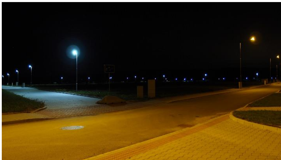
Obrázek 4 – běžné bílé LED osvětlení (vlevo, 4000 K) versus LED PC-Amber osvětlení (vpravo, 1800 K), zdroj 54
