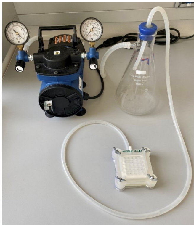
Obrázek 12. Sestavená aparatura affiblotu, affiblot napojen na odpadní láhev a vakuum (vlastní foto)
