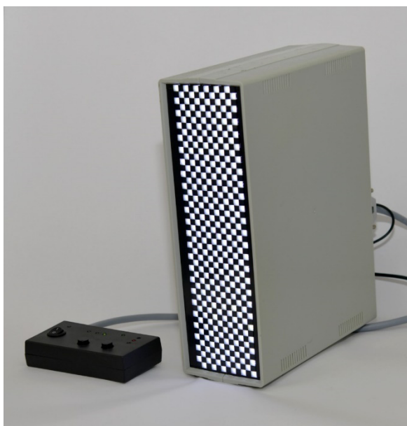
Obr. 6 Druhý prototyp stimulatoru LED. Obrázek ukazuje přístroj v provozu se zobrazeným vzorem, ve vertikální poloze používané při stimulaci, připojen je i dálkový ovladač.
