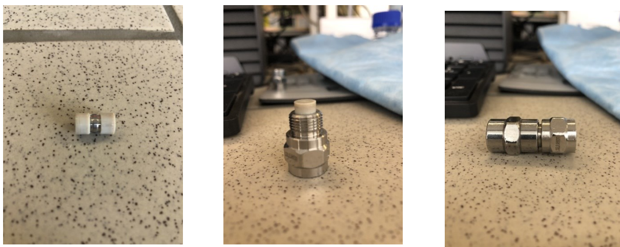
Obrázek 17: Naplněná kolonka připravená k zapojení do systému
