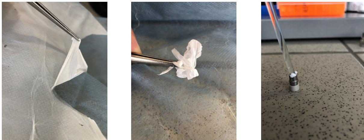
Obrázek 16: Proces plnění kolonky nanovláknny
