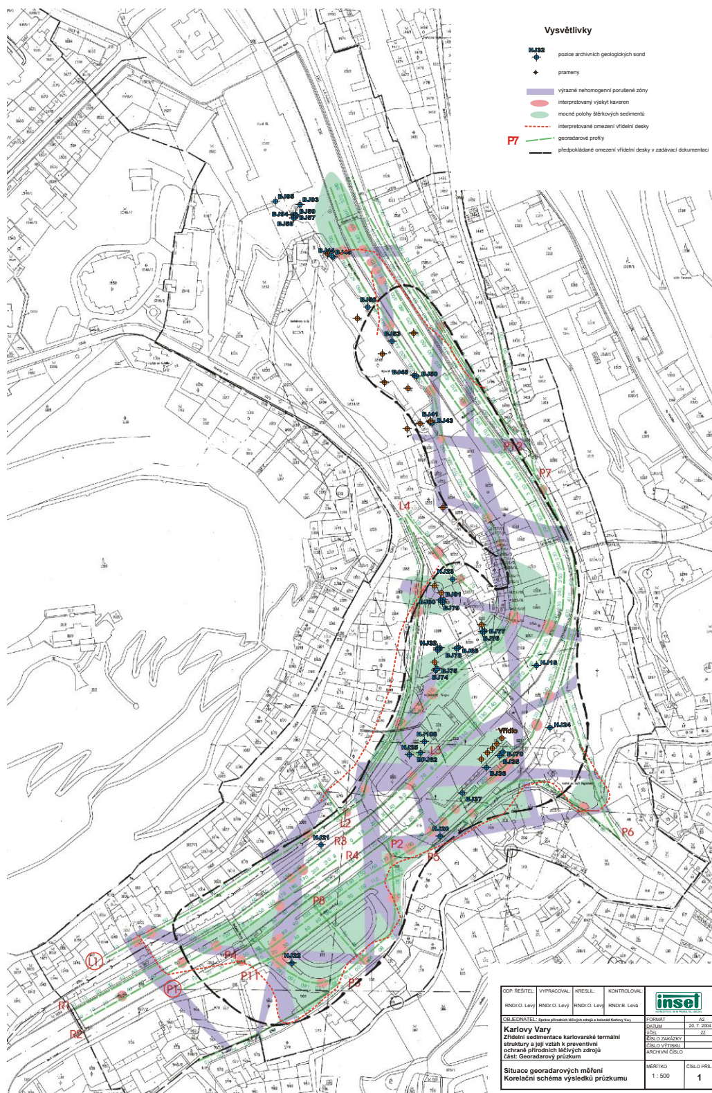
Obr. 6 Interpretační mapa georadarových měření s vyznačením profilů
