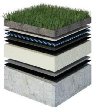
Obr. 1: Vrstvy zelených střech (Karafiát, 2015)
