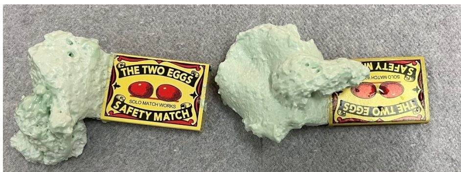
Obrázek 18 Suchá (vlevo) a mokrá (vpravo) krabička od zápalek po vytvoření polyuretanové pěny.
