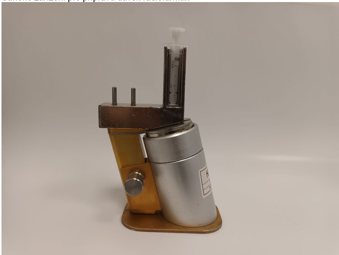
Stíněné zařízení pro přípravu dávek radiofarmak
