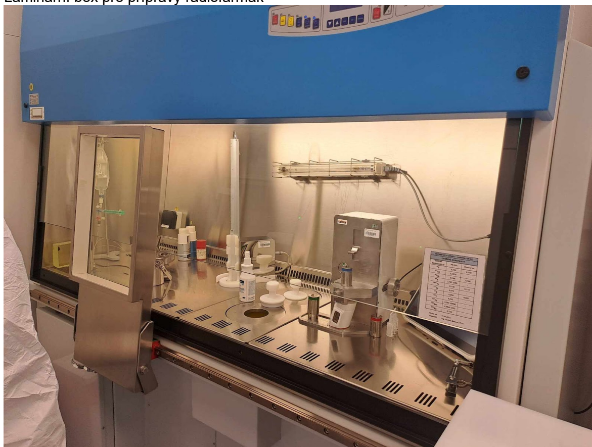
Laminární box pro přípravy radiofarmak
