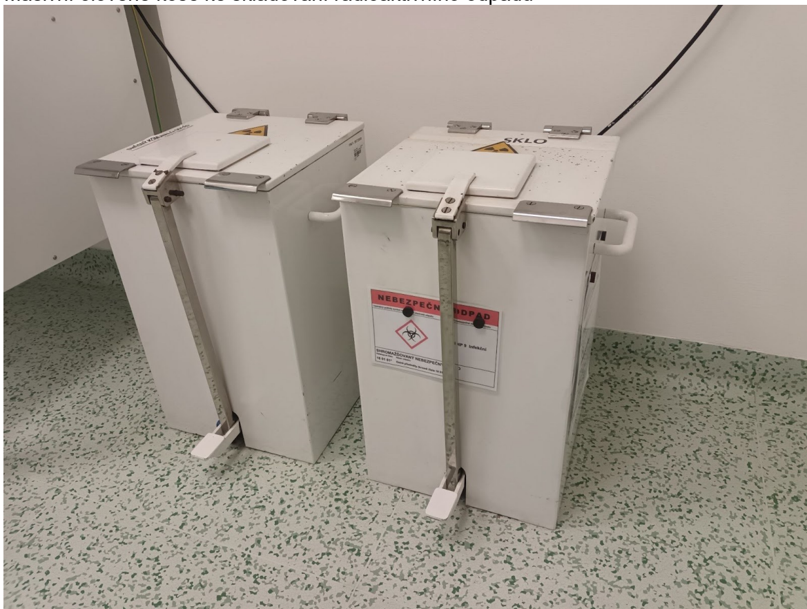
Masivní olověné koše ke skladování radioaktivního odpadu
