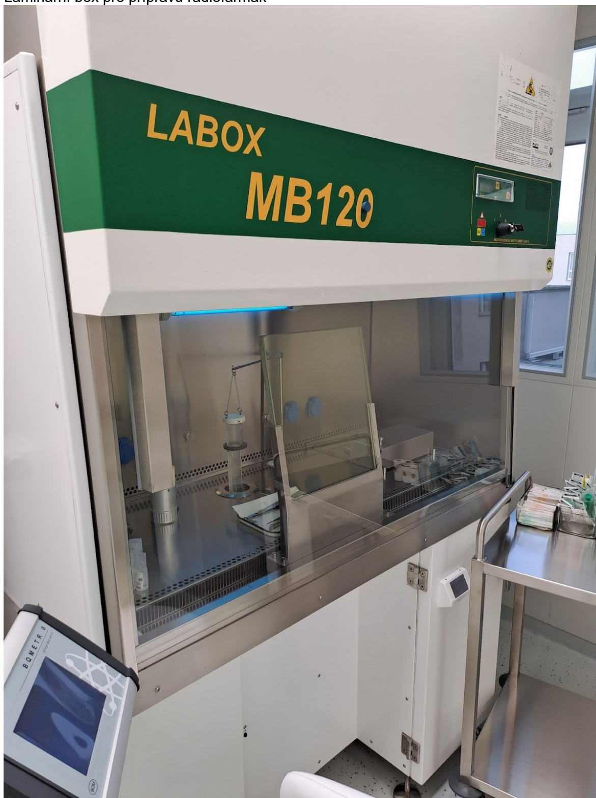
Laminární box pro přípravu radiofarmak
