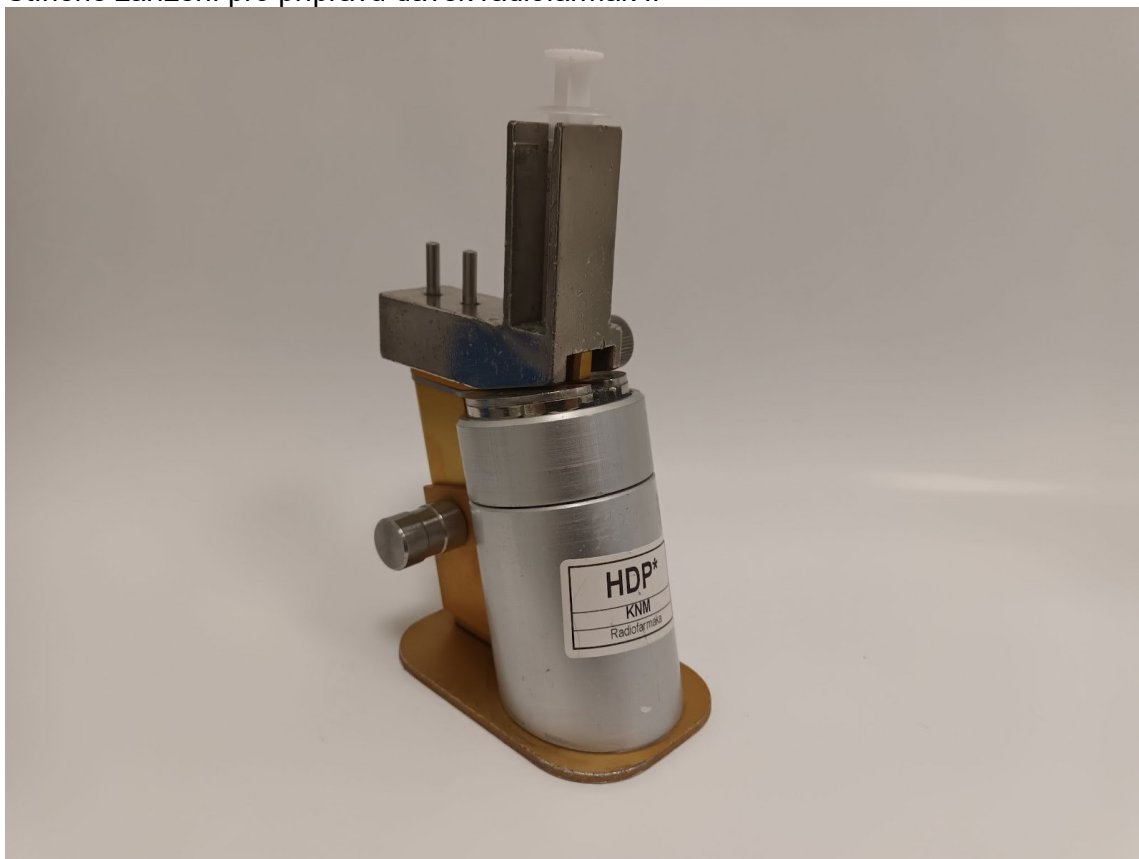
Stíněné zařízení pro přípravu dávek radiofarmak II
