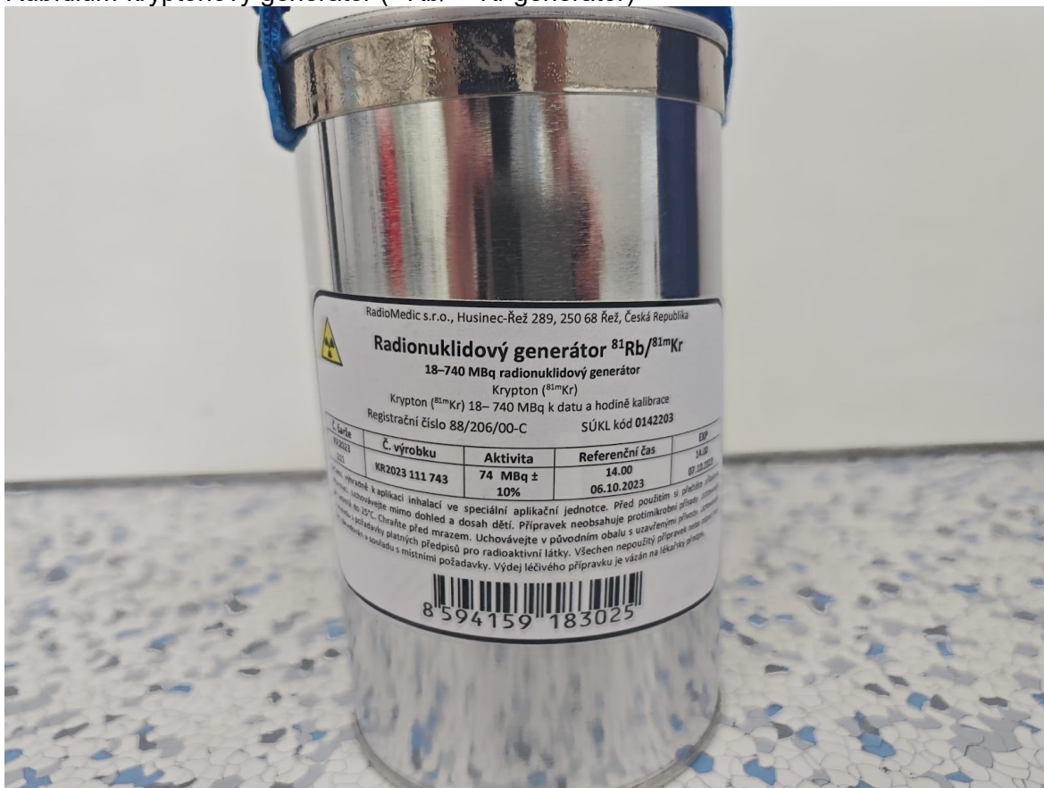
Rubidium-kryptonový generátor ( ^{81}\text{Rb}/^{81\text{m}}\text{Kr} generátor)
