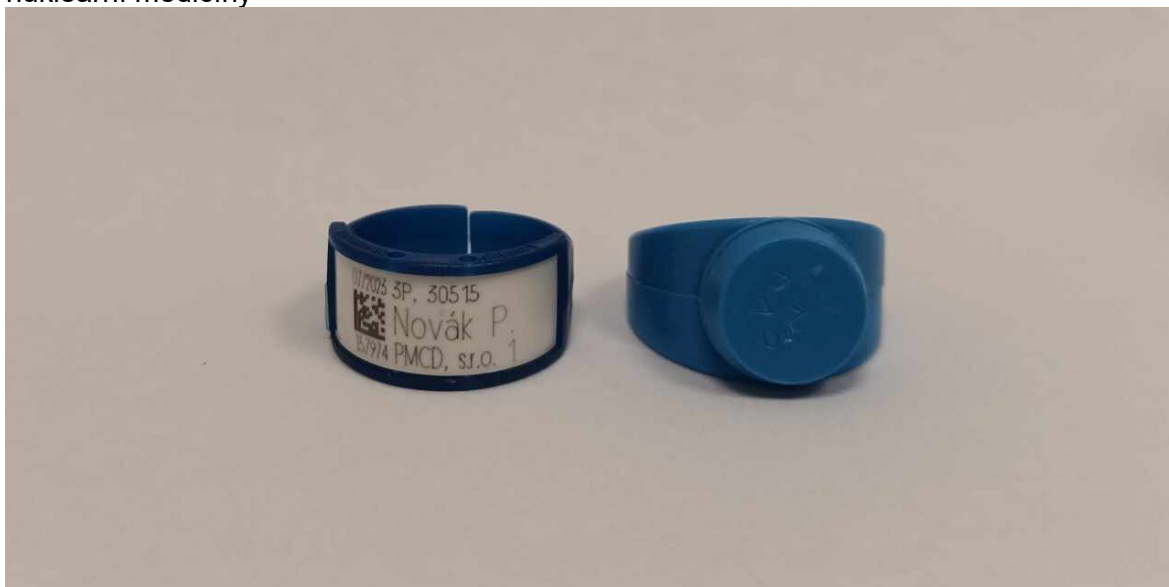
Prstové dozimetry monitorující pohlcené záření na ruku zaměstnance na oddělení nukleární medicíny
