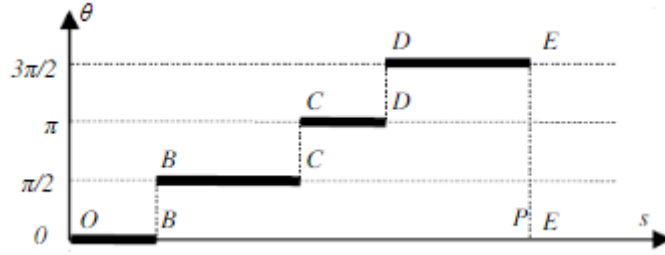
Obrázek 5-3 \theta značí hodnotu Turning function v daném segmentu s . Zdroj: Volotao et al. 2010
