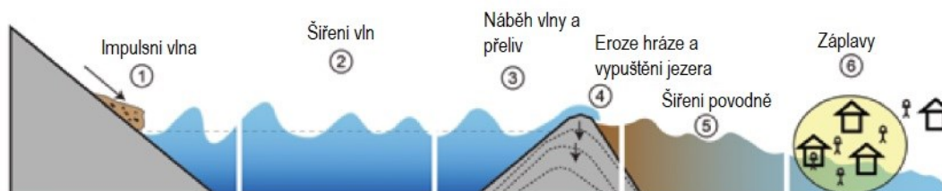
Obrázek 10: Schematický náčrt řetězce impulsu pohybu hmoty u ledovcových jezer Zdroj: (Allen et al., 2017)
