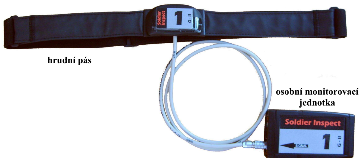
Obr. 3 – Hrudní pás a osobní monitorovací jednotka
