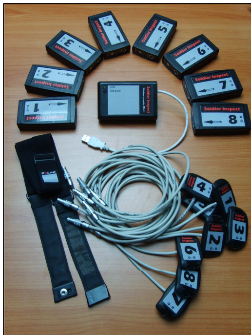
Obr. 1 – Dohledový systém, 8 osobních monitorovacích jednotek (OMJ) včetně hrudních pásů. Uprostřed modul pro příjem bezdrátového signálu od OMJ.
